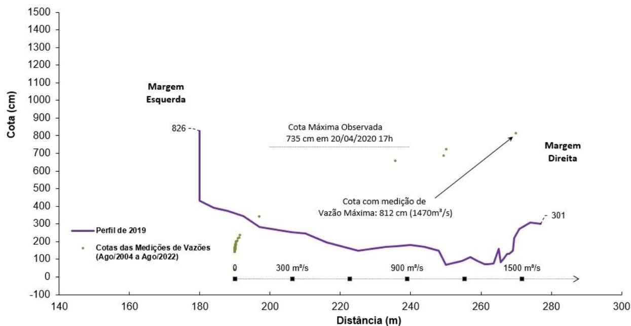
Figura 03 – Perfil da seção transversal da seção de réguas de Sítio Curralinho. Falha de leitura às 7h do dia 30/04/2009 implicou em falta de registro de cota máxima observada acima da cota máxima com medição de vazão (812 cm 30/04/2009 12h).
