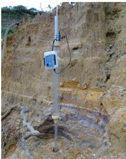
**Figura 1.** Permeâmetro de Guelph utilizado para avaliação da condutividade hidráulica saturada no campo (Kfs)
