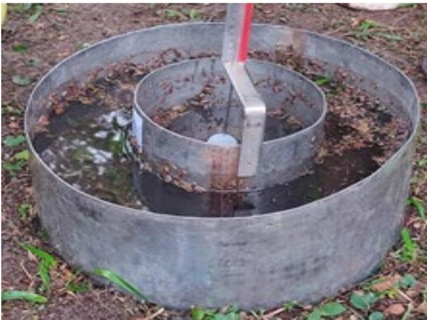
**Figura 3.** Infiltrômetro de duplo anel utilizado nas avaliações da taxa de infiltração básica (TIB).
