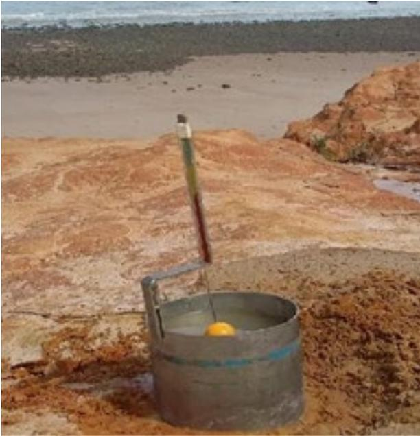
**Figura 2.** Infiltrômetro de anel simples (*single ring*) utilizado nas avaliações da taxa de infiltração básica (TIB).
