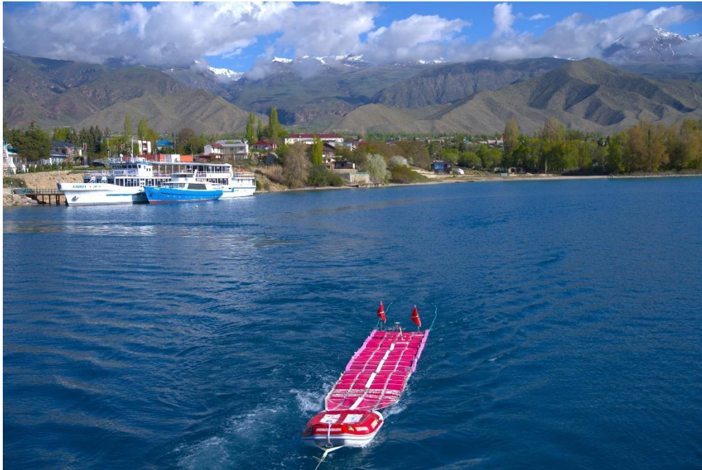
Figura 8 – Coleta de dados da linha de água do Lago Issyk-Kul com receptores GNSS embarcados na plataforma CALNAGEO.
