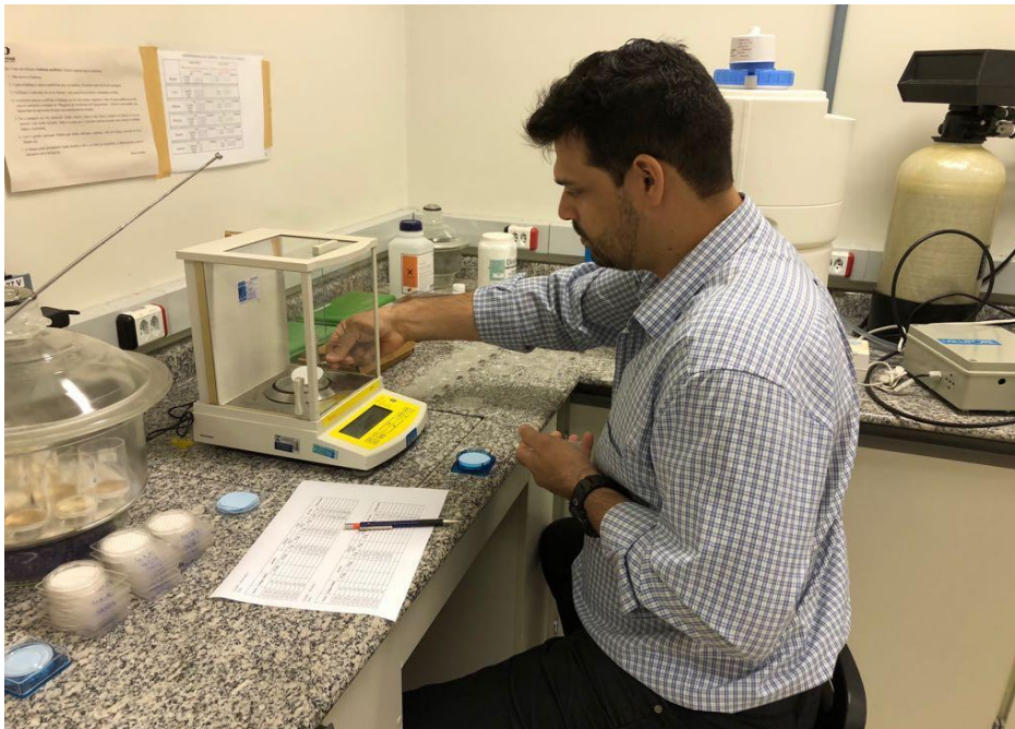
Figura 3 - Pesquisador em Geociências André Santos realizando pesagem dos filtros em balança de precisão, ação fruto da parceria com o LAMIN Manaus.
