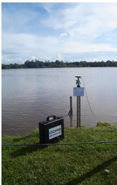
Figura 4 - Ocupação de um lance de régua por receptor GPS para nivelamento da estação fluviométrica de Porto União.
