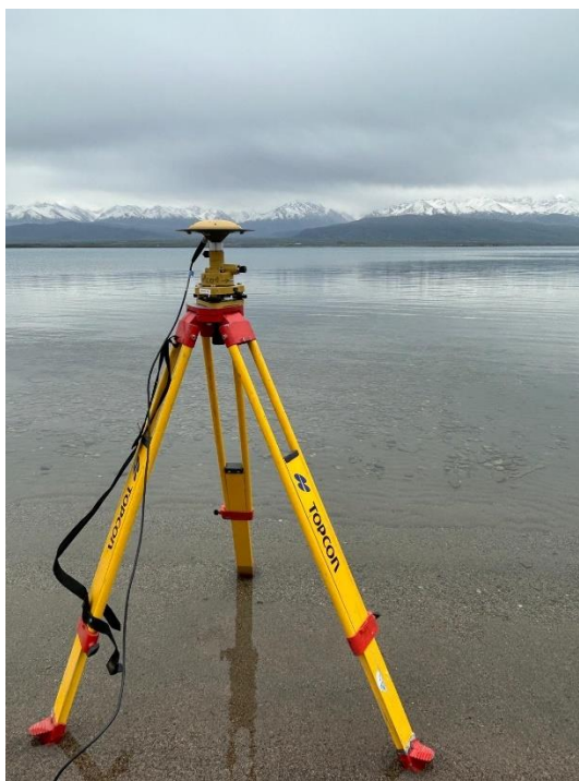
Figura 9 – Instalação de receptores GNSS na borda do lago Issyk-kul para nivelamento da linha de água do lago.
