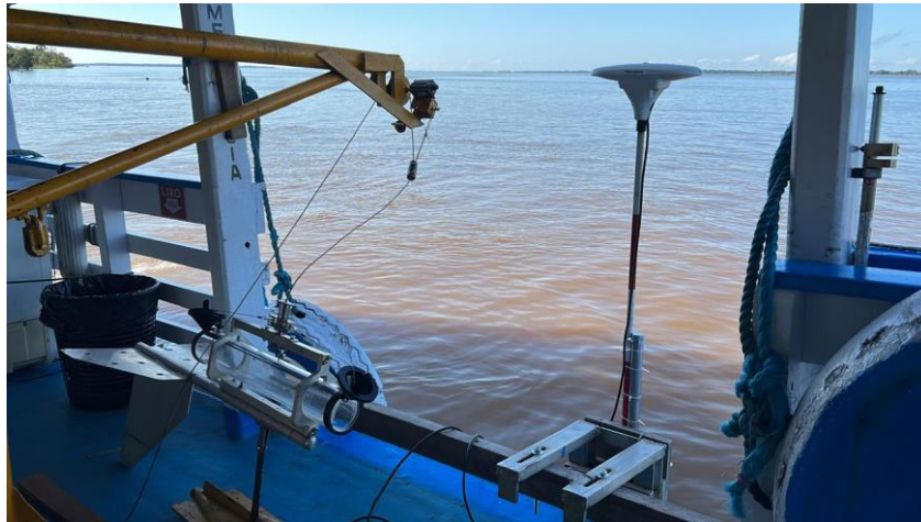
Figura 15 – Amostrador de sedimentos pontual, aDcp imerso e antena GPS na amostragem de sedimentos.
