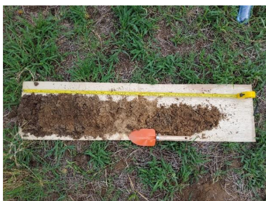
Figura 13. Sedimentos obtidos com trado no Rio Perucaba. Fonte: Autores
