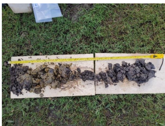
Figura 14. Sedimentos obtidos com trado no Rio Piauí. Fonte: Autores
