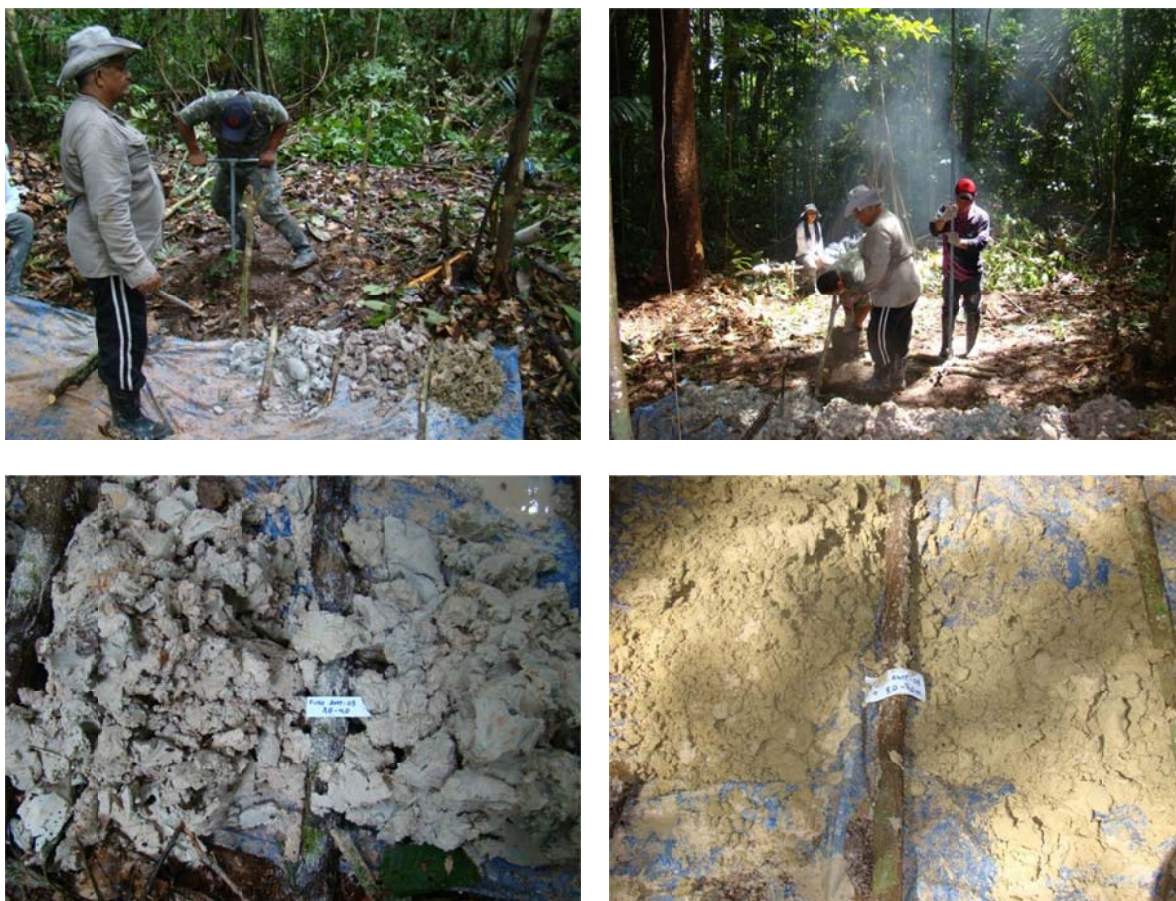
Figura 7: Aspectos da perfuração e do material atravessado em dois intervalos do furo AMT-05
