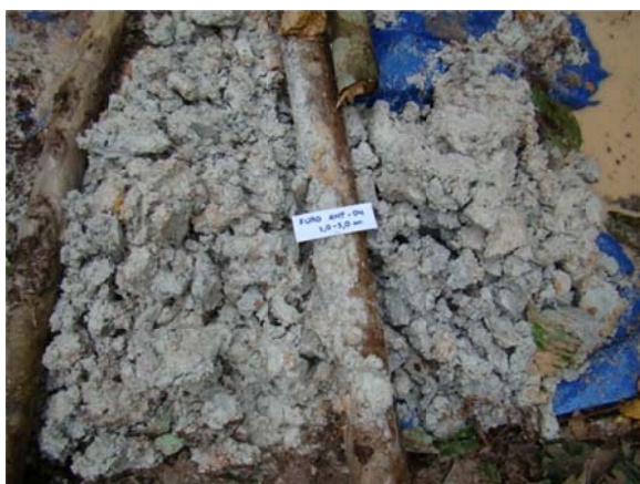
Figura 6: Aspectos da perfuração e do material atravessado em dois intervalos do furo AMT-04.
