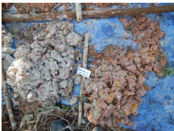
Figura 5: Aspectos da perfuração e do material atravessado em dois intervalos do furo AMT-03.
