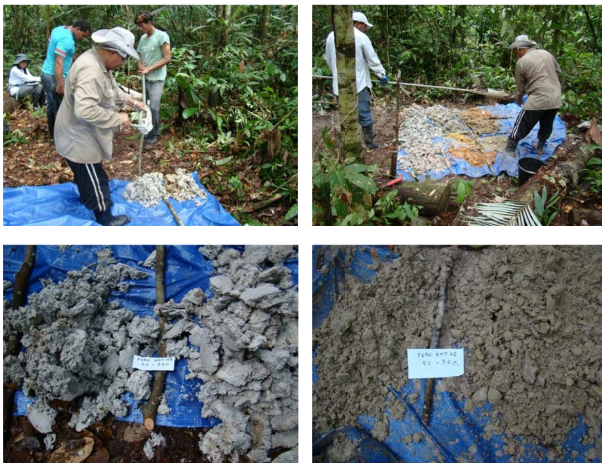
Figura 4: Aspectos da perfuração e do material atravessado em dois intervalos do furo AMT-02.
