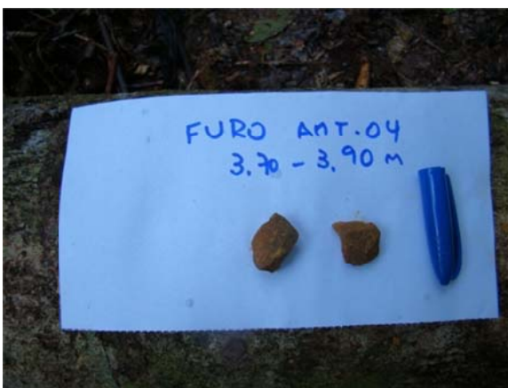
Figura 6: Aspectos da perfuração e do material atravessado em dois intervalos do furo AMT-04.
