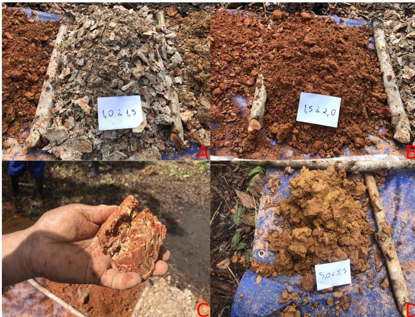
**Figura 13:** Furo ANAM-02. A) Padrão mosqueado acamadado, com predomínio de material branco argilo-siltoso. B) Material granular (areno-siltoso) vermelho e amarelo. C) Padrão acamadado mosqueado, com predomínio de material vermelho, areno-silto-argiloso do intervalo 4,00 a 4,50m. D) Areia siltosa amarela, já molhada, do fim do furo.
