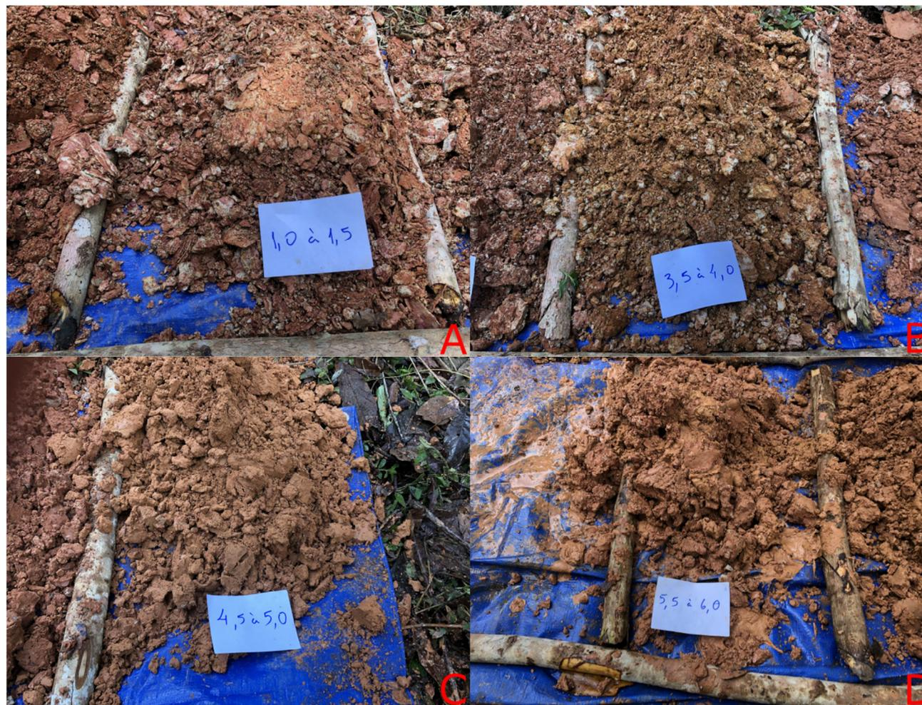
**Figura 15:** Furo ANAM-04. A) Solo argilo-siltoso, marrom avermelhado, com pintas e camadas brancas. B) Solo silto-areno-argiloso, acamadado branco e vermelho, com pintas de laterita e manchas amarelas esporádicas. C) Areia vermelha retirada no intervalo precedente ao lençol freático. D) Areia vermelha retirada após a interseção do lençol freático.
