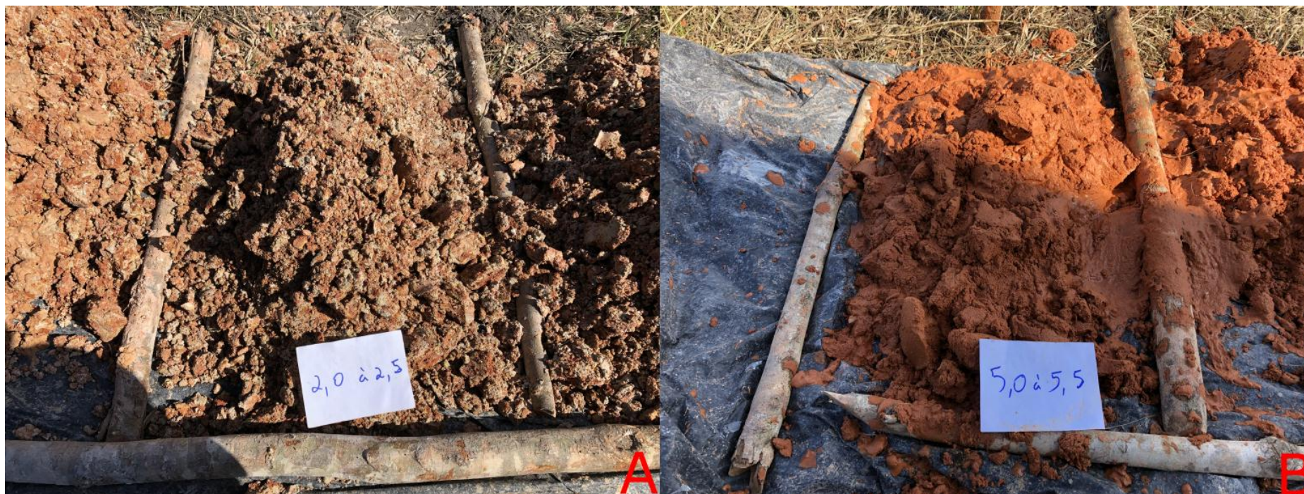
Figura 15: Furo ANOR-04. A) Material areno-argiloso vermelho, intercalado com branco, e com pintas de laterita, do intervalo 2,0 a 2,5m. B) Areia vermelha, comum em profundidade nessa região.
