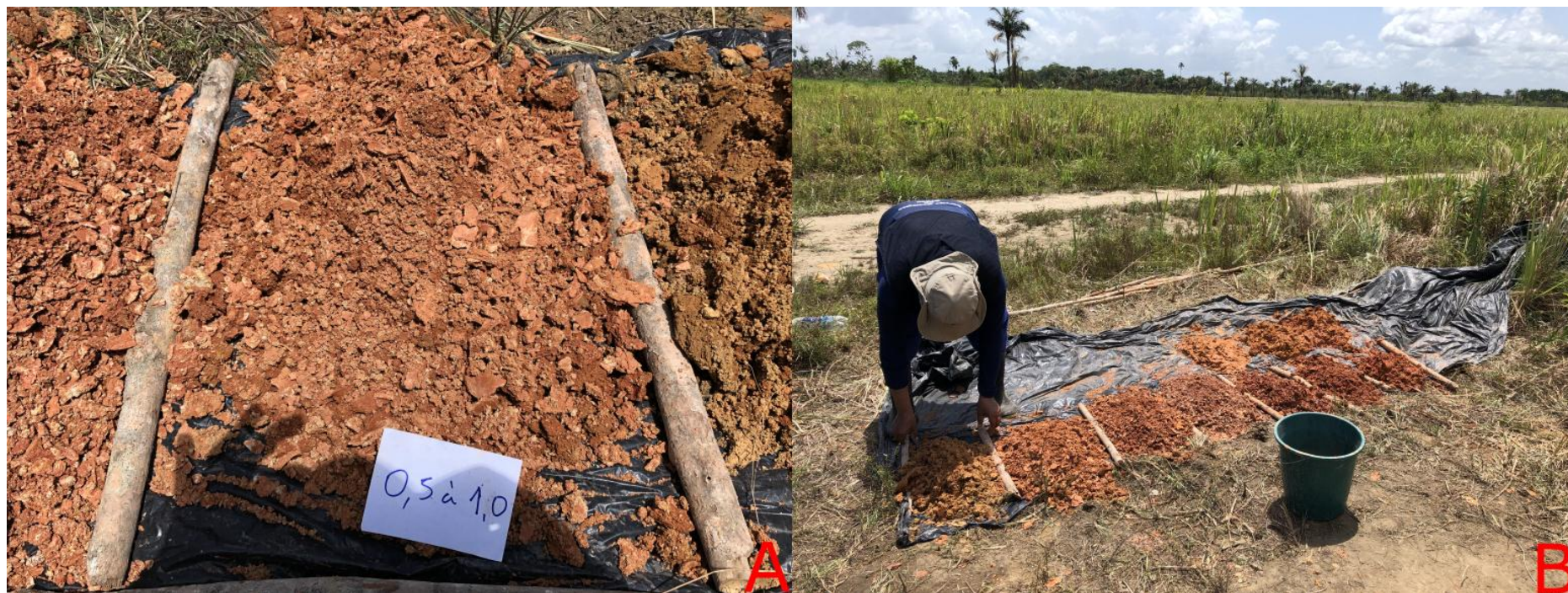
Figura 16: Furo ANOR-05. A) Argila siltosa marrom clara, com pintas vermelhas de laterita, no intervalo 0,5 a 1,0m. B) A disposição final das amostras ao término do furo.
