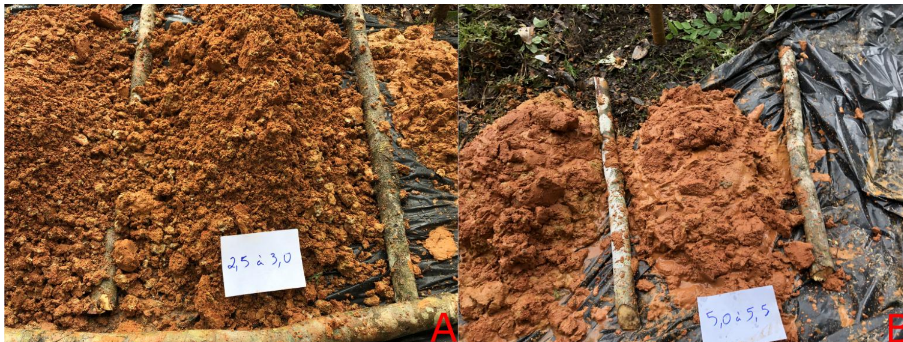
Figura 12: Furo ANOR-01. A) Intervalo laterítico areno-siltoso coeso. B) O material do final do furo, com amplo predomínio de areia vermelha, abaixo do lençol freático, apresenta-se sem coesão.
