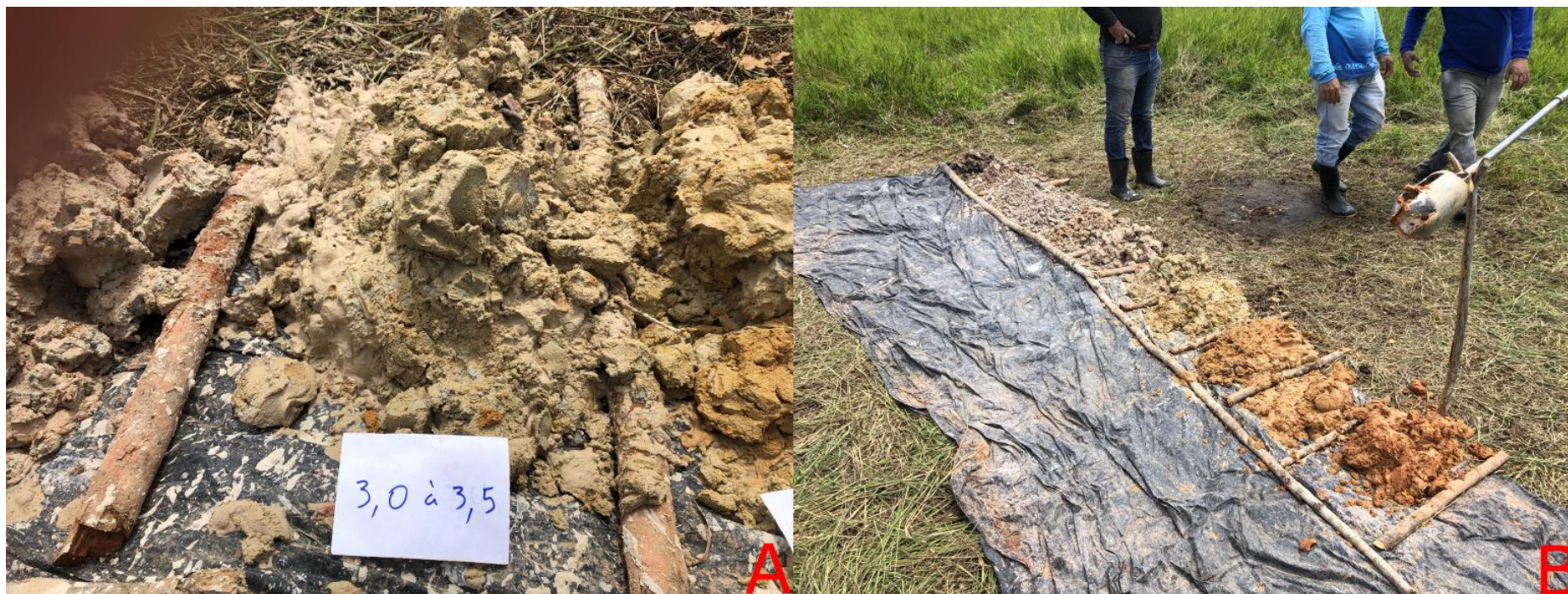
Figura 14: Furo ANOR-03. A) Material areno-argiloso, branco, mesclado com material vermelho e amarelo, retirado do intervalo 3,0 a 3,5m. B) Disposição final do material ao término da perfuração.
