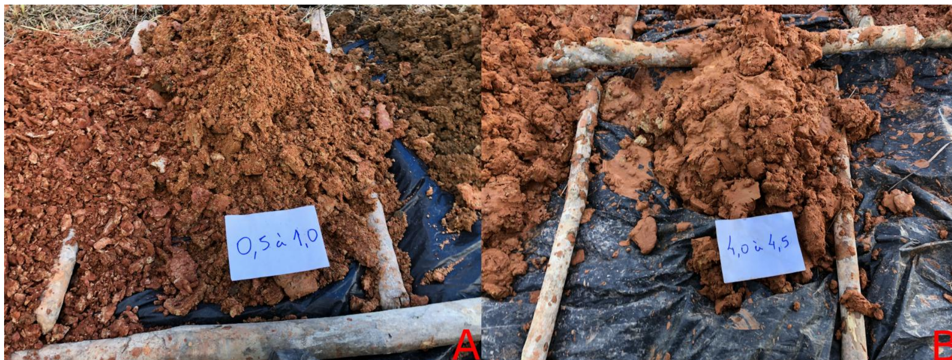
Figura 17: Furo ANOR-06. A) Solo marrom claro, com argila branca incipiente, do intervalo 0,5 a 1,0m. B) Ao final, a comum areia vermelha aparece novamente.
