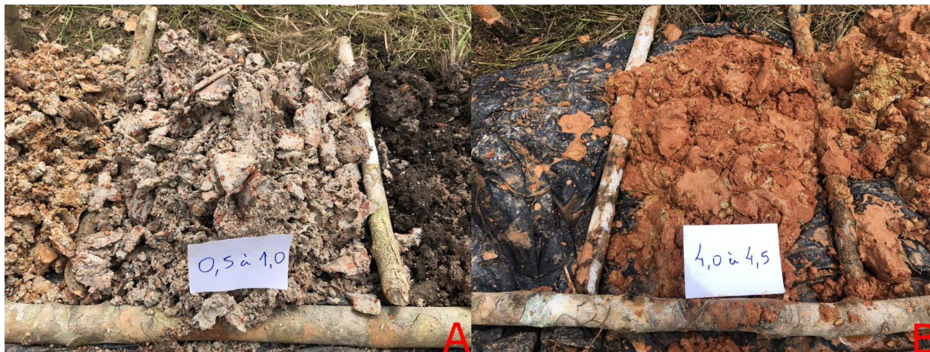
Figura 13: Furo ANOR-02. A) Material cinza-esbranquiçado do início do furo, argiloso, com pintas vermelhas friáveis de laterita. B) A parte final do furo, com areia vermelha sem coesão, muito comum em zonas mais profundas do solo da região.
