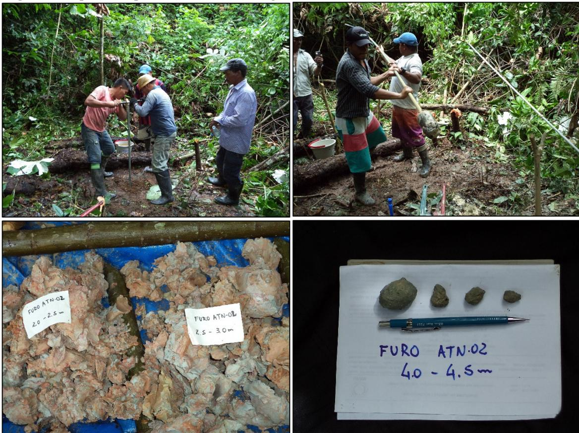
**Figura 10:** Aspectos da perfuração e dos solos atravessados em dois intervalos do furo ATN-02, com destaque, na última foto, para as pelotas argilosas endurecidas.
