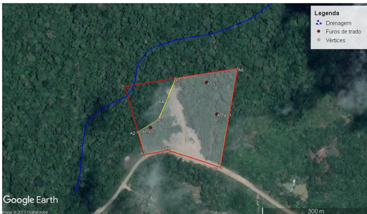
**Figura 8:** Imagem de satélite de alta resolução (Google Earth, agosto/2017) com a situação da área total avaliada (em vermelho, 6,0 ha) e da área resultante do detalhamento (em transparência, 4,8 ha), com a localização dos furos de trado realizados e da drenagem que a corta. Os pontos A1 a A8 são os vértices da área de 4,8 ha, cujas coordenadas são informadas no próximo item.
