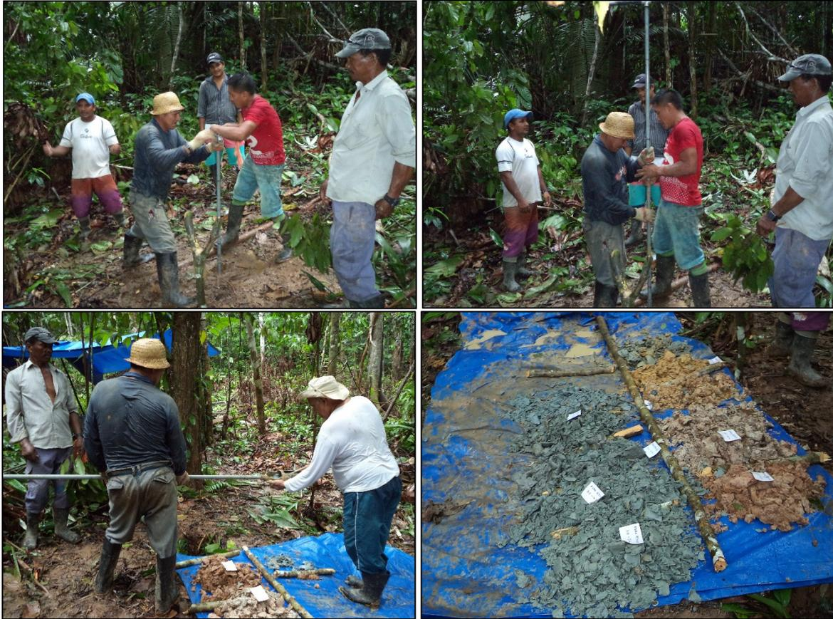
**Figura 11:** Aspectos da perfuração e de todo o perfil de solo/subsolo atravessado pelo furo ATN-03.
