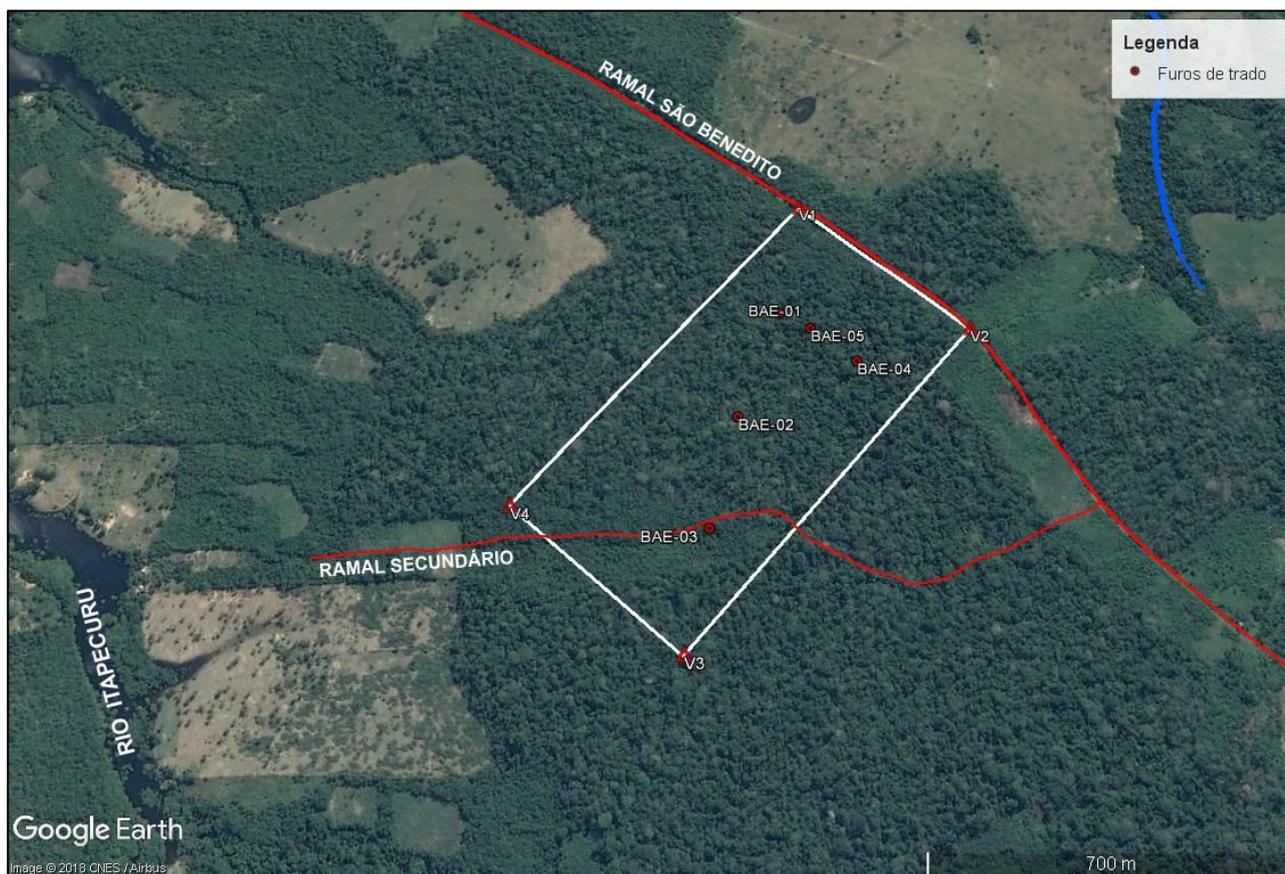
**Figura 8:** Imagem de satélite de alta resolução (Google Earth) com a situação em detalhe da área de 50ha avaliada para implantação do aterro sanitário de Barreirinha, com a localização dos cinco furos de trado realizados e das drenagens mais próximas. Os pontos V1 a V4 são os vértices da área, cujas coordenadas geográficas estão informadas na Tabela 2.
