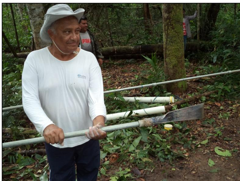
**Figura 9:** Ferramenta utilizada para tentar romper a crosta laterítica, encontrada no furo BAE-01 a 4,90m de profundidade e nos furos BAE-02, 03 e 04 respectivamente a 4,80, 5,20 e 4,30m.
