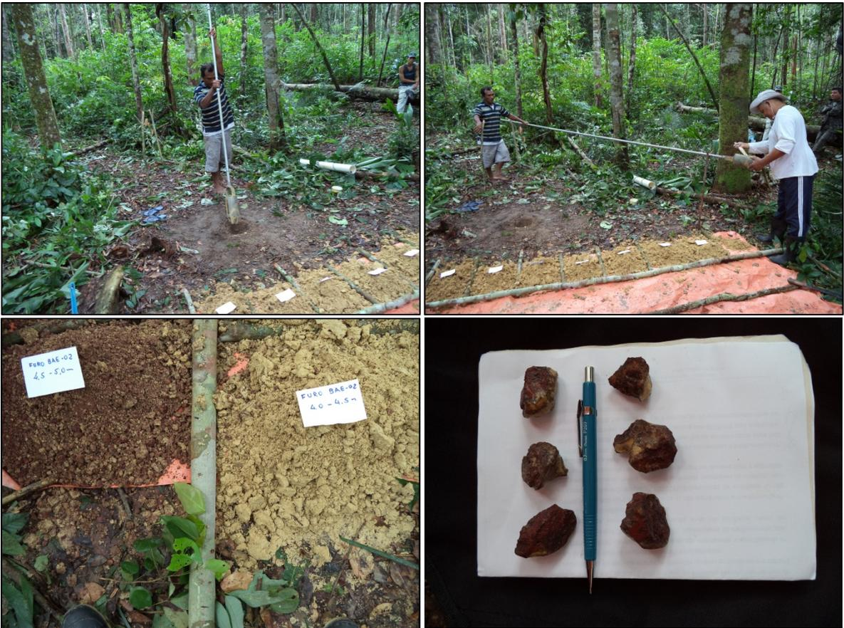
**Figura 11:** Perfuração do furo BAE-02 e fragmentos da crosta laterítica encontrada a 4,8m de profundidade.
