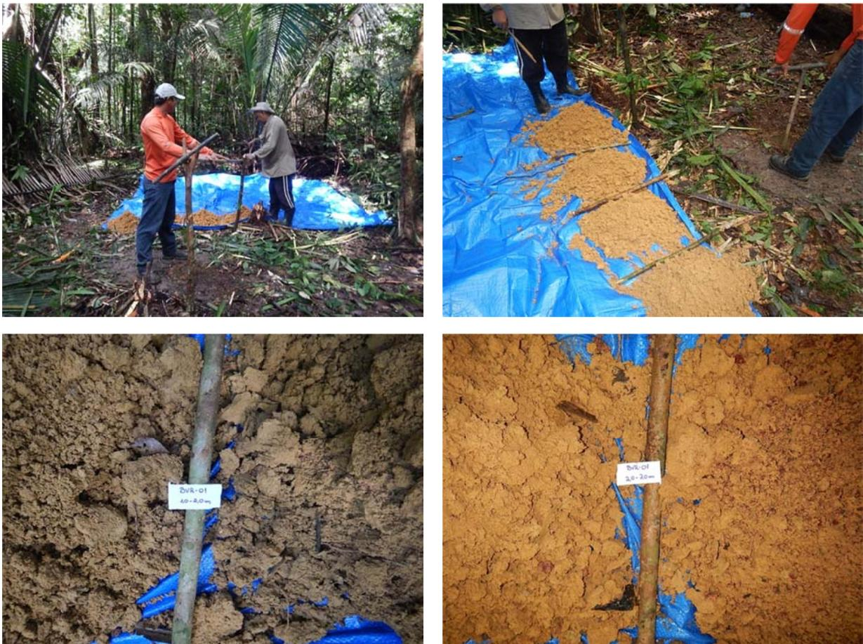
Figura 5: Aspectos da perfuração e do material atravessado em dois intervalos do furo BVR-01.
