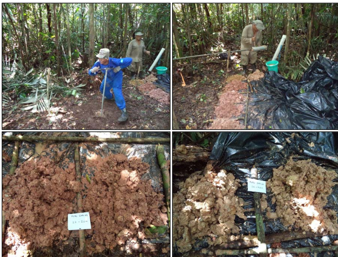
Figura 8: Aspectos da perfuração e do material argiloso atravessado em dois intervalos do furo CAR-01.
