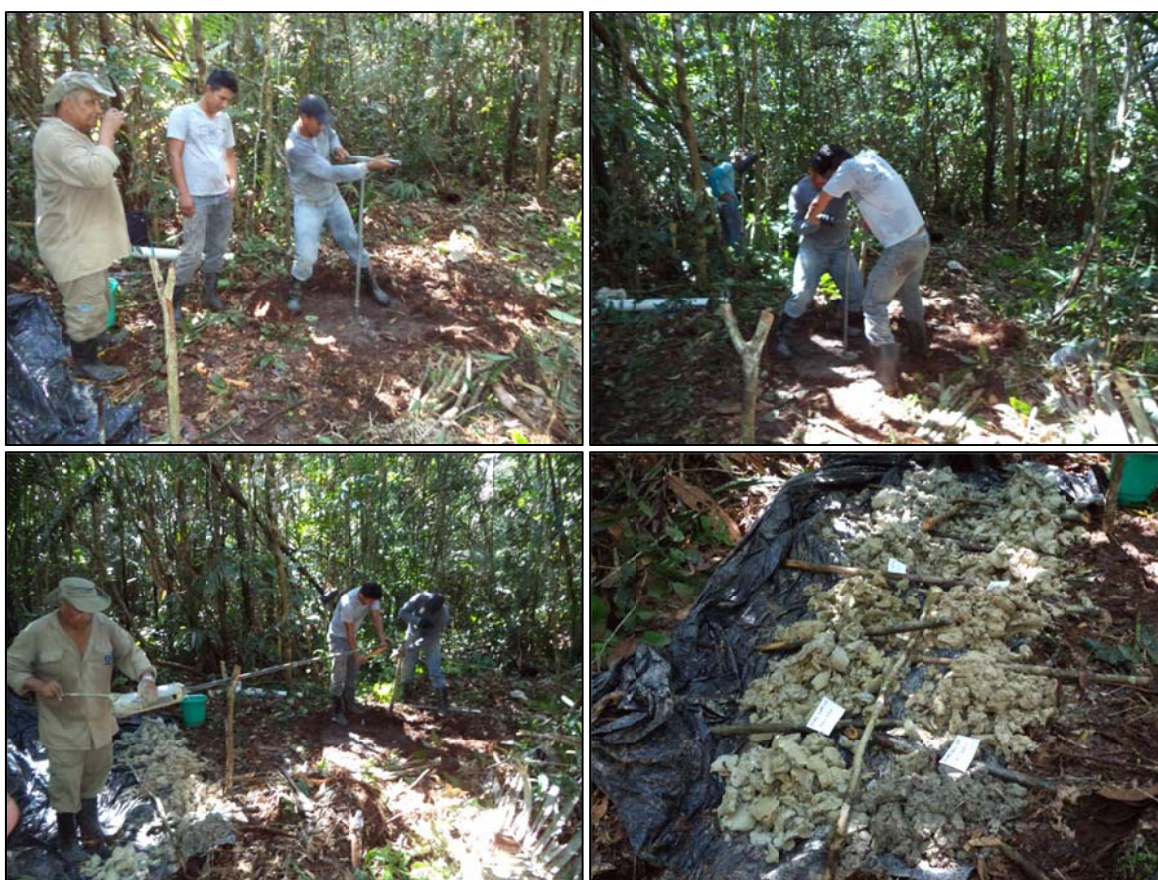
Figura10: Aspectos da perfuração e de todo material argiloso atravessado pelo furo CAR-03.
