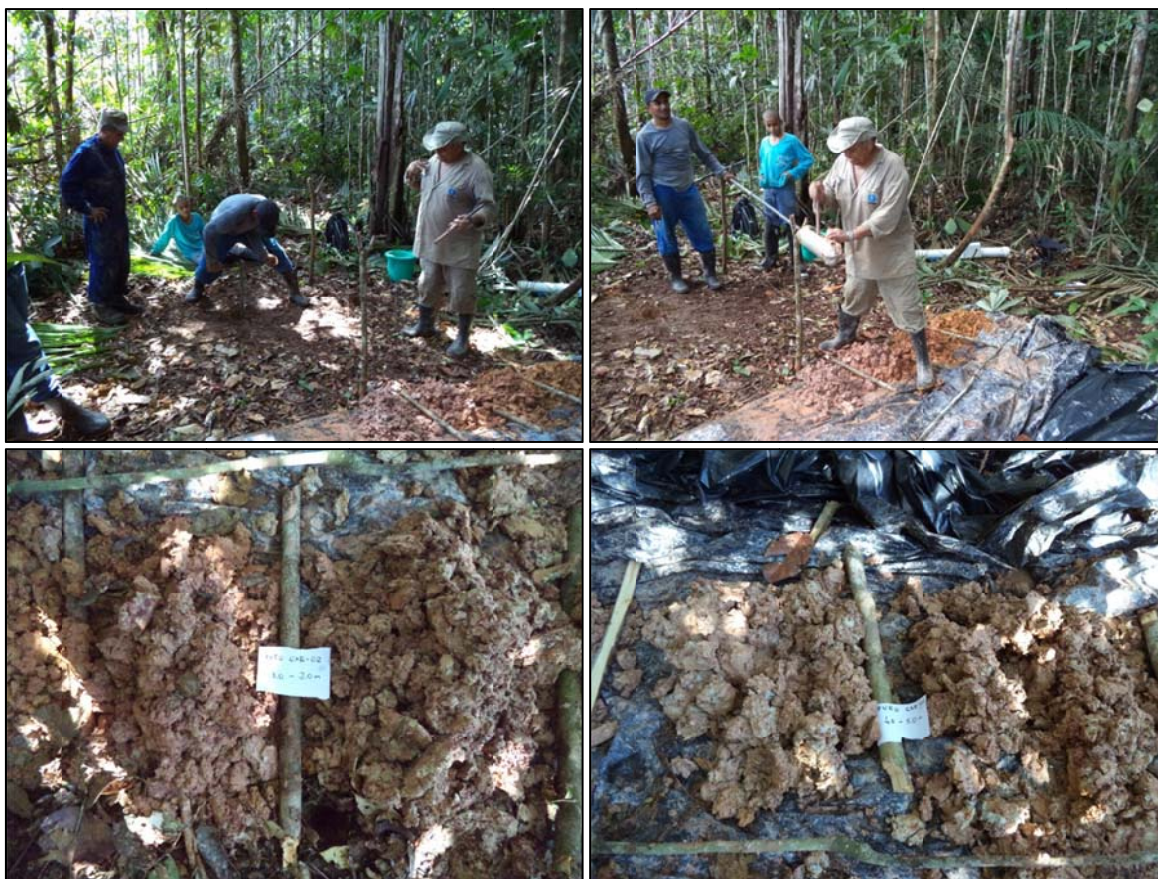
Figura 9: Aspectos da perfuração e do material argiloso atravessado em dois intervalos do furo CAR-02.
