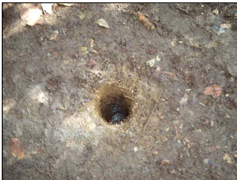
Figura 11: Coluna d'água no furo CAR-02 gerada a partir da infiltração contínua, pelas paredes do furo, das águas de chuva acumuladas na sub-superfície do terreno.
