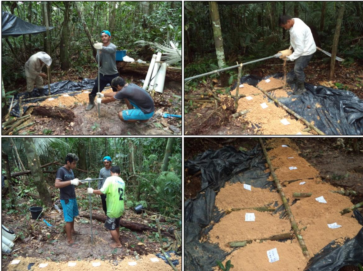
**Figura 8:** Aspectos da perfuração e de todo horizonte de solo argilo-siltoso atravessado pelo furo RPE-01.
