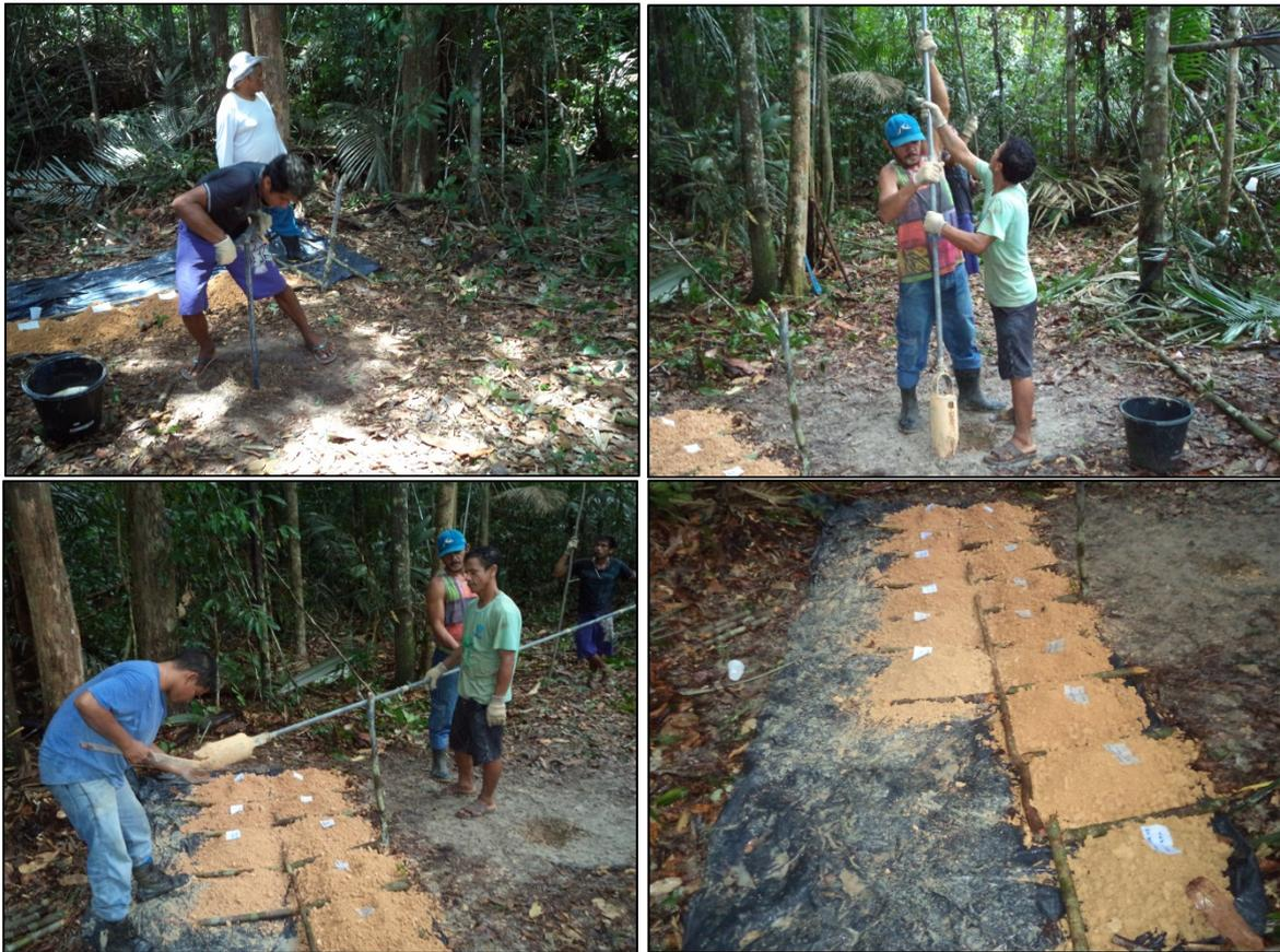
**Figura 10:** Aspectos da perfuração e do solo argiloso a silto-argiloso atravessado pelo furo RPE-03.
