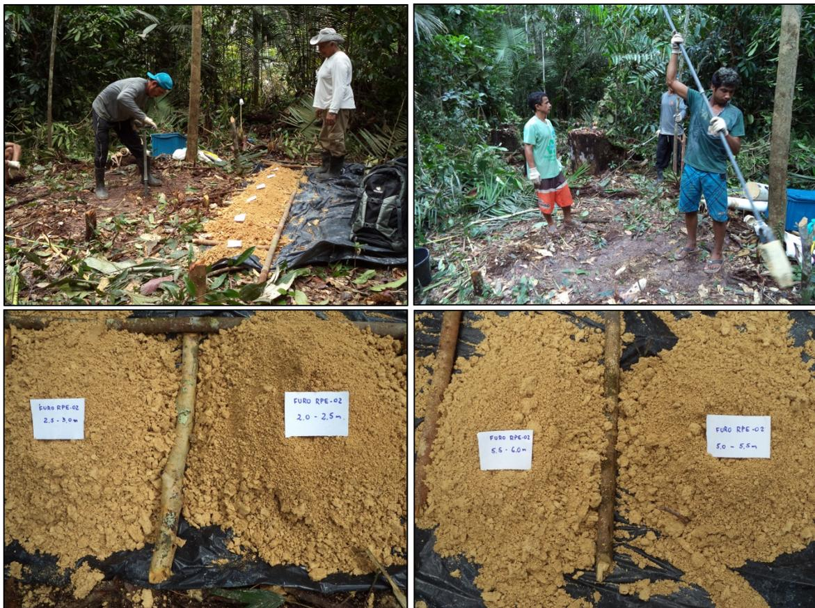
**Figura 9:** Aspectos da perfuração e dos solos atravessados em dois intervalos do furo RPE-02.
