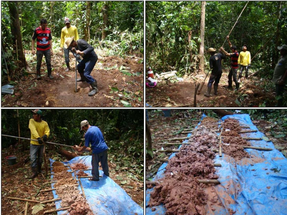
**Figura 6:** Aspectos da perfuração e de todo material atravessado pelo furo JUT-02.
