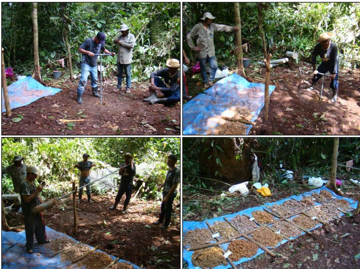
**Figura 7:** Aspectos da perfuração e de todo material atravessado pelo furo JUT-03.
