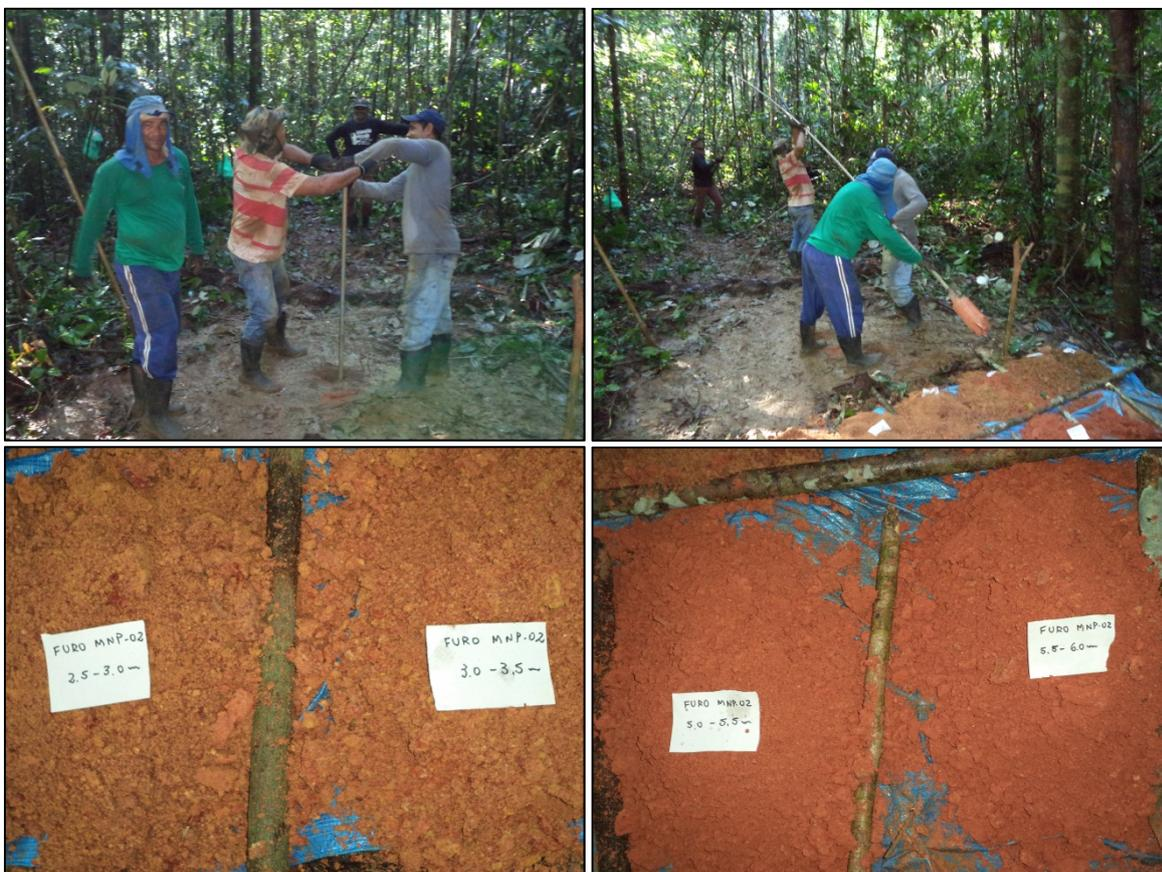
**Figura 8:** Aspectos da perfuração e dos solos atravessados em dois intervalos do furo MNP-02.
