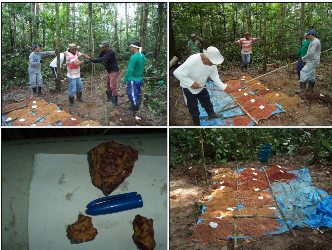
**Figura 7:** Perfuração do furo MNP-01, fragmentos da camada laterítica encontrada entre 1,3m e 1,7m de profundidade e vista de todo solo/subsolo atravessado pela sondagem.
