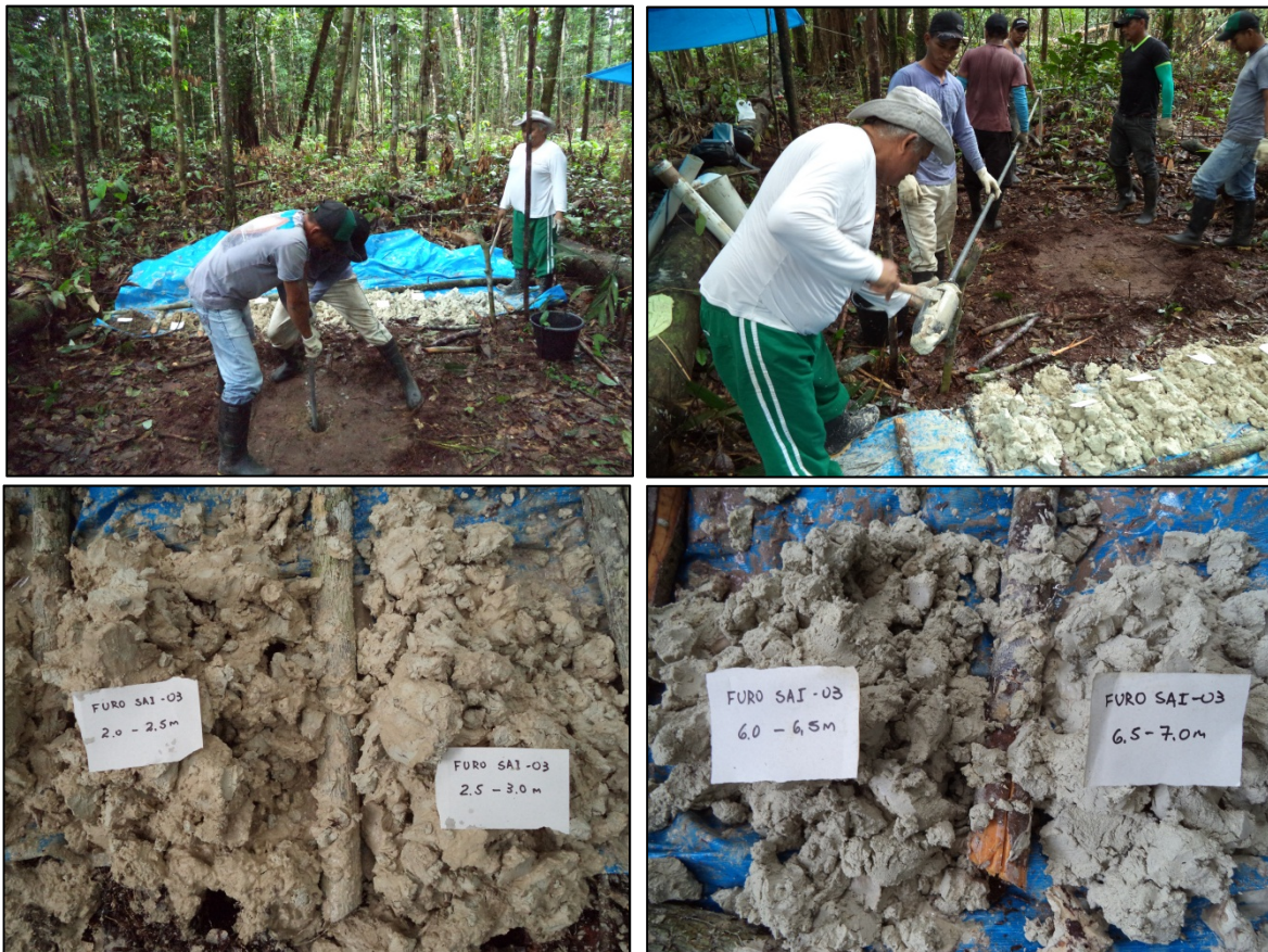
Figura 10: Aspectos da perfuração e do material atravessado em dois intervalos do furo SAI-03.
