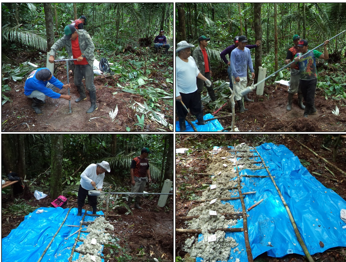
Figura 8: Aspectos da perfuração e de todo perfil de solo areno-argiloso atravessado pelo furo SAI-01.
