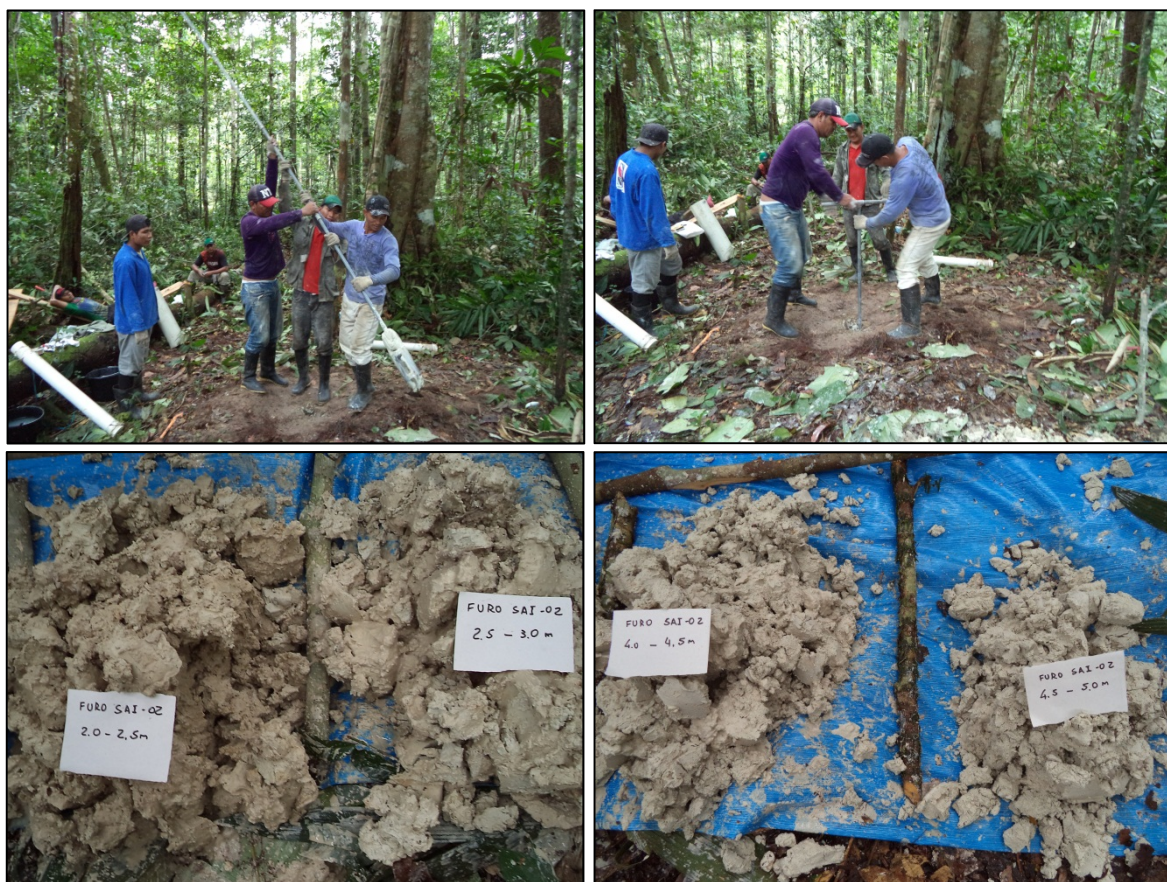
Figura 9: Aspectos da perfuração e do material atravessado em dois intervalos do furo SAI-02.
