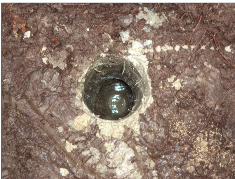
Figura 12: Coluna d'água no furo SAI-04 gerada a partir da infiltração contínua, pelas paredes do furo, das águas de chuva acumuladas na subsuperfície do terreno do entorno (vide Figura 5).
