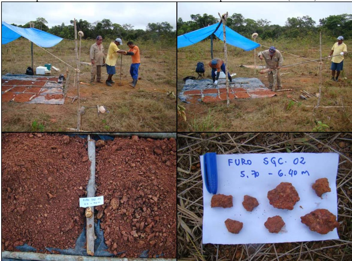
Figura 10: Aspectos da perfuração e do material atravessado em dois intervalos do furo SGC-02.
