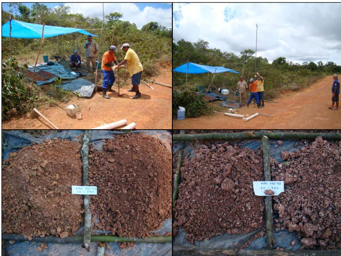
Figura 11: Aspectos da perfuração e do material atravessado em dois intervalos do furo SGC-03.
