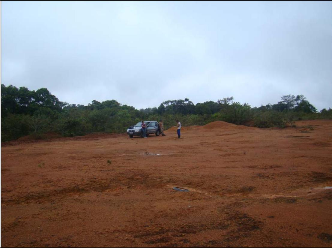
Figura 6: Vista do limite oeste da área avaliada, onde se observa local em que foi extraída piçarra (cascalho laterítico), com espessura de até 1,5m, para revestimento de estradas.
