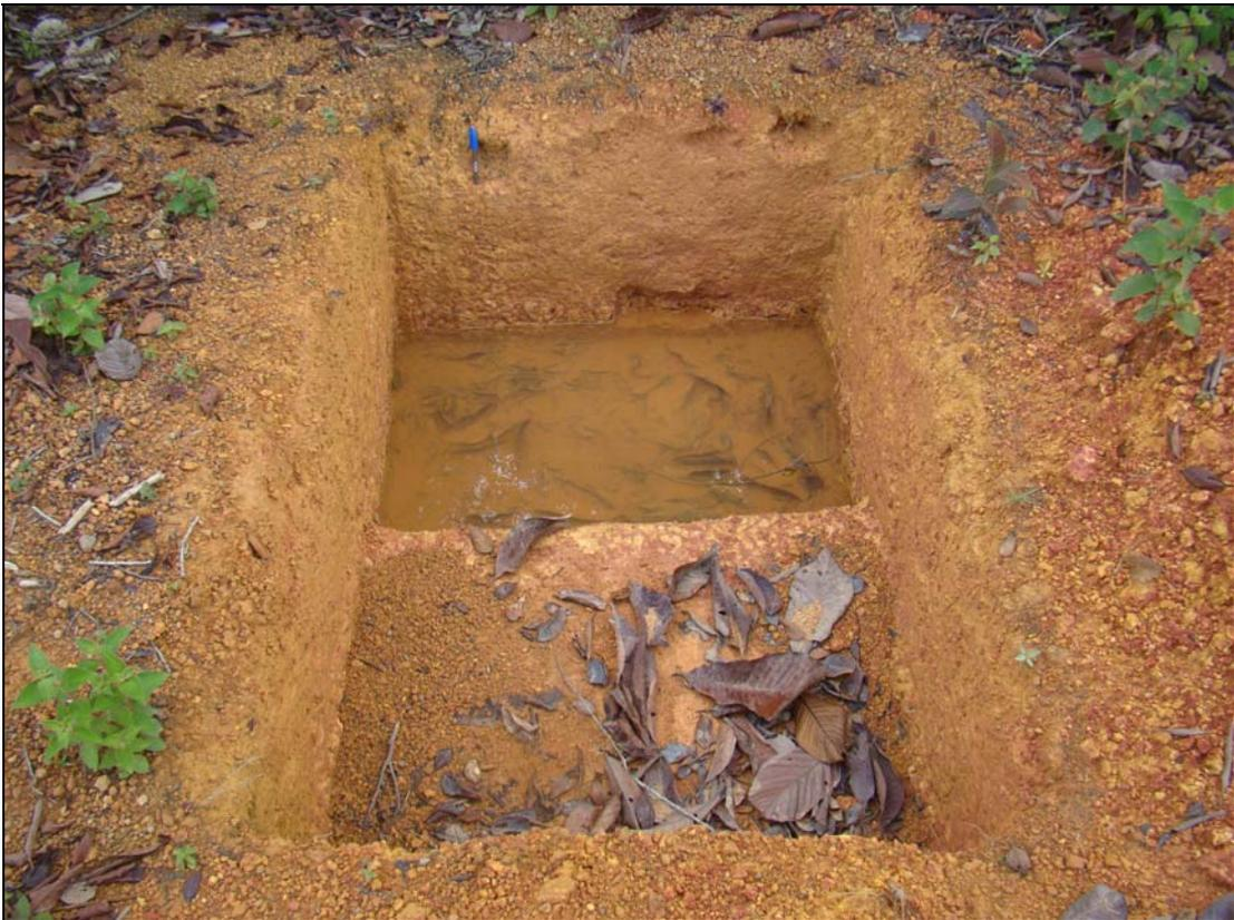
Figura 7: Trincheira aberta no terreno mostrado na foto anterior para prospecção da espessura da camada de piçarra no local.
