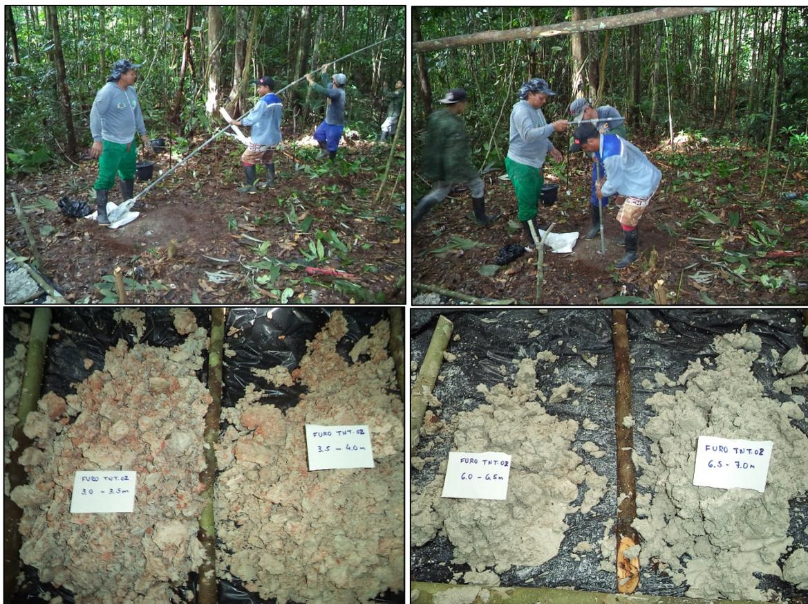
**Figura 7:** Aspectos da perfuração e do material atravessado em dois intervalos do furo TNT-02.
