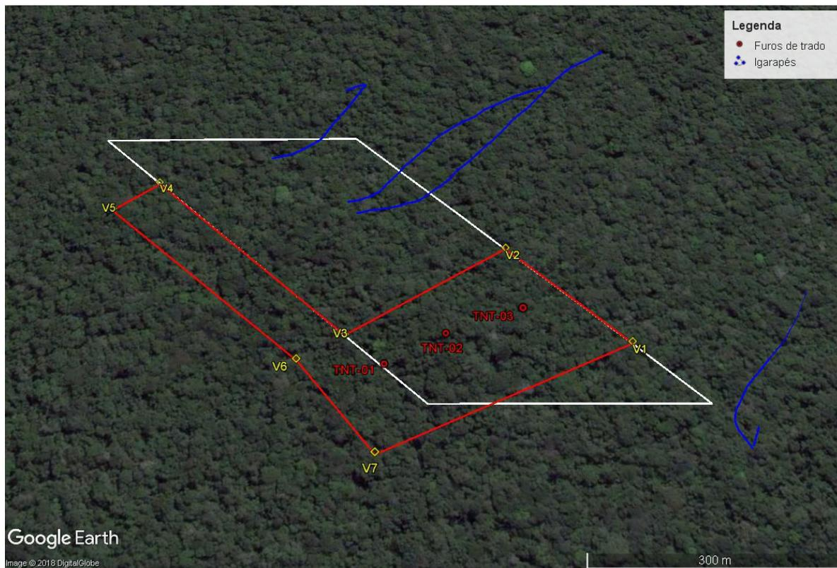
**Figura 5:** Imagem de satélite de alta resolução (Google Earth) com a situação da área total avaliada (em branco, 14 ha) e da área resultante do detalhamento (em vermelho, 8 ha), com a localização dos furos de trado realizados. Os pontos V1 a V7 são os vértices da área indicada para o aterro, cujas coordenadas são informadas no próximo item.
