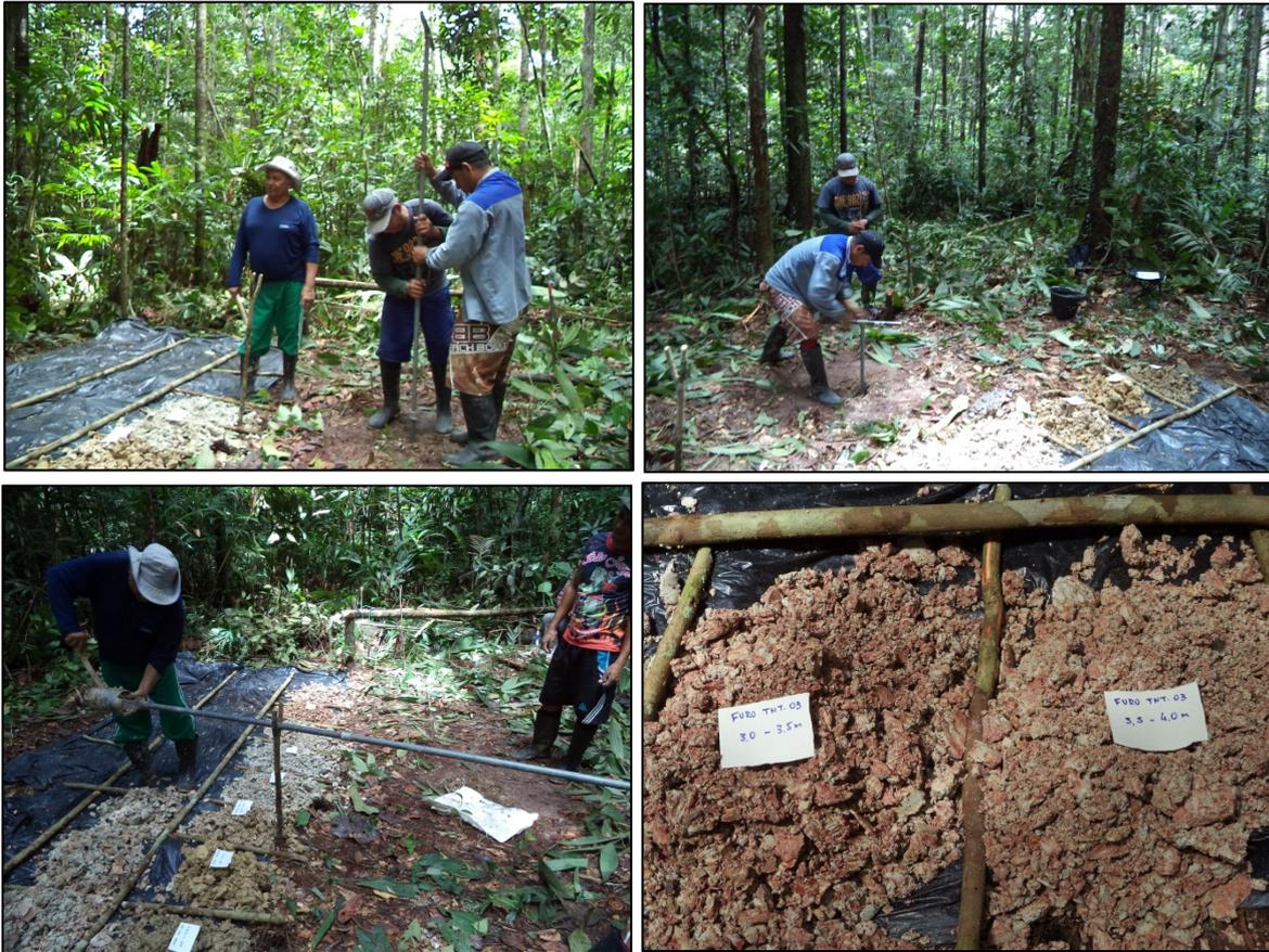
**Figura 8:** Aspectos da perfuração e do solo siltico-argiloso atravessado pelo furo TNT-03.
