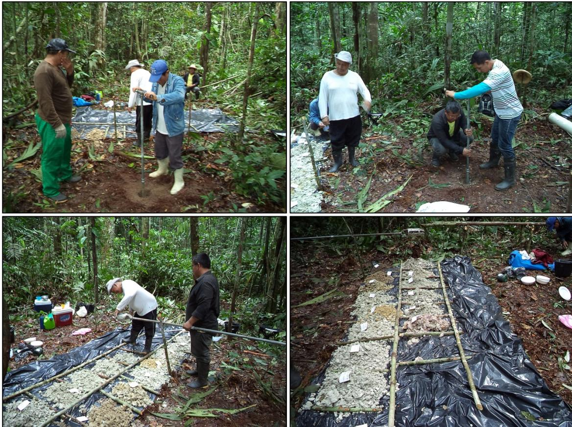
**Figura 6:** Aspectos da perfuração e de todo material atravessado pelo furo TNT-01.
