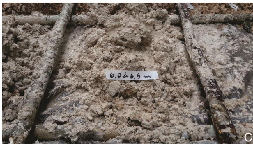
Figura 11: A) Material rosáceo tirado do intervalo de 2,20 a 4,75 metros. B) Nódulos grandes de laterita são encontrados nas zonas mais avermelhadas. C) Material cinzento arenoso encontrado no fim do furo. D) Todo o material do furo é disposto sobre a lona para descrição, fotografia e coleta.
