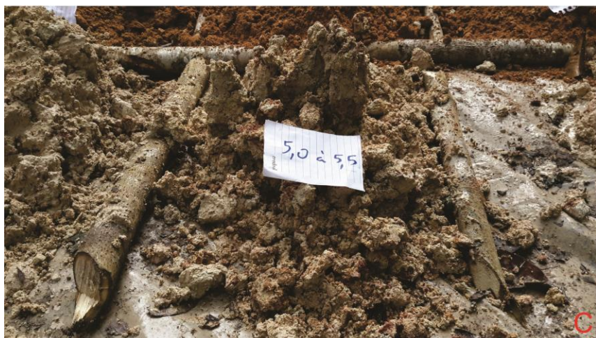
Figura 14: A) Material laranja/amarelo retirado do intervalo de 0,70 a 2,70 metros. B) Material claro (creme) retirado do intervalo de 4,50 a 5,00 metros. C) Material mais vermelho, com muitas manchas e nódulos de laterita, do intervalo de 5,00 a 5,50 metros. D) O material apresenta coesão boa, sendo amostrado, por vezes, no formato da boca do trado.
