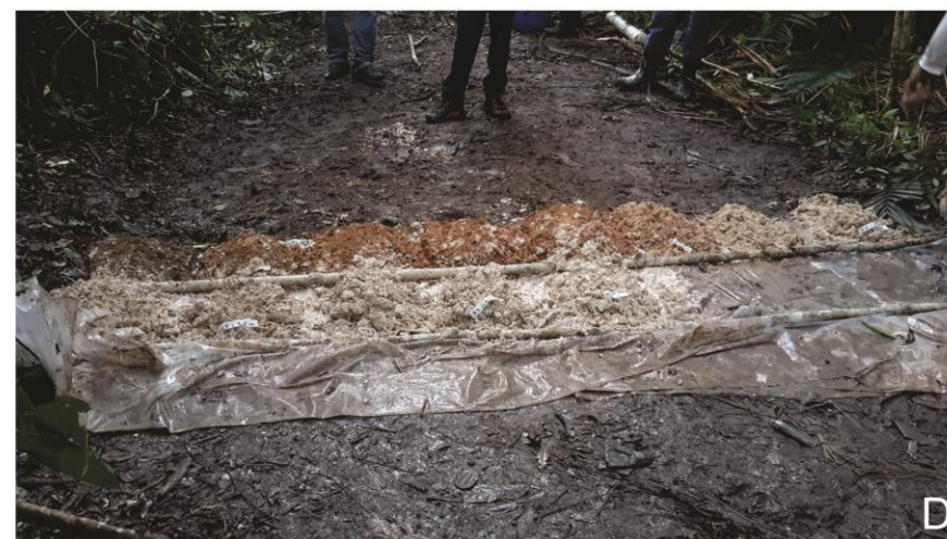
Figura 11: A) Material rosáceo tirado do intervalo de 2,20 a 4,75 metros. B) Nódulos grandes de laterita são encontrados nas zonas mais avermelhadas. C) Material cinzento arenoso encontrado no fim do furo. D) Todo o material do furo é disposto sobre a lona para descrição, fotografia e coleta.
