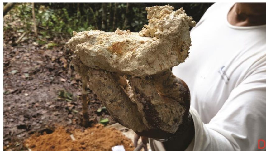
Figura 14: A) Material laranja/amarelo retirado do intervalo de 0,70 a 2,70 metros. B) Material claro (creme) retirado do intervalo de 4,50 a 5,00 metros. C) Material mais vermelho, com muitas manchas e nódulos de laterita, do intervalo de 5,00 a 5,50 metros. D) O material apresenta coesão boa, sendo amostrado, por vezes, no formato da boca do trado.
