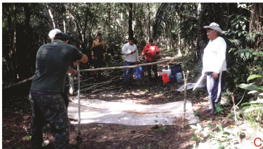
Figura 12: A) Material rosáceo retirado no intervalo entre 2,50 a 3,50 metros. B) Material creme retirado no intervalo 3,50 a 5,50 metros. C) Processo de perfuração se iniciando, com duas pessoas girando o trado e a lona estendida para recepção do material.
