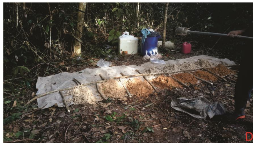
Figura 13: A) Processo de limpeza do local antes do início da perfuração. B) Horizonte orgânico argilo-arenoso marrom escuro. C) Material claro (creme) retirado do intervalo entre 3,50 e 6,00 metros. D) Material disposto na lona.
