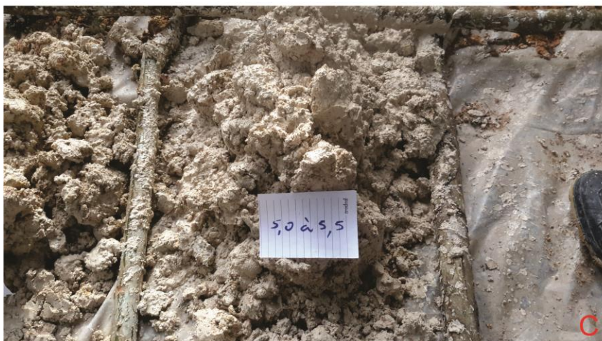
Figura 13: A) Processo de limpeza do local antes do início da perfuração. B) Horizonte orgânico argilo-arenoso marrom escuro. C) Material claro (creme) retirado do intervalo entre 3,50 e 6,00 metros. D) Material disposto na lona.
