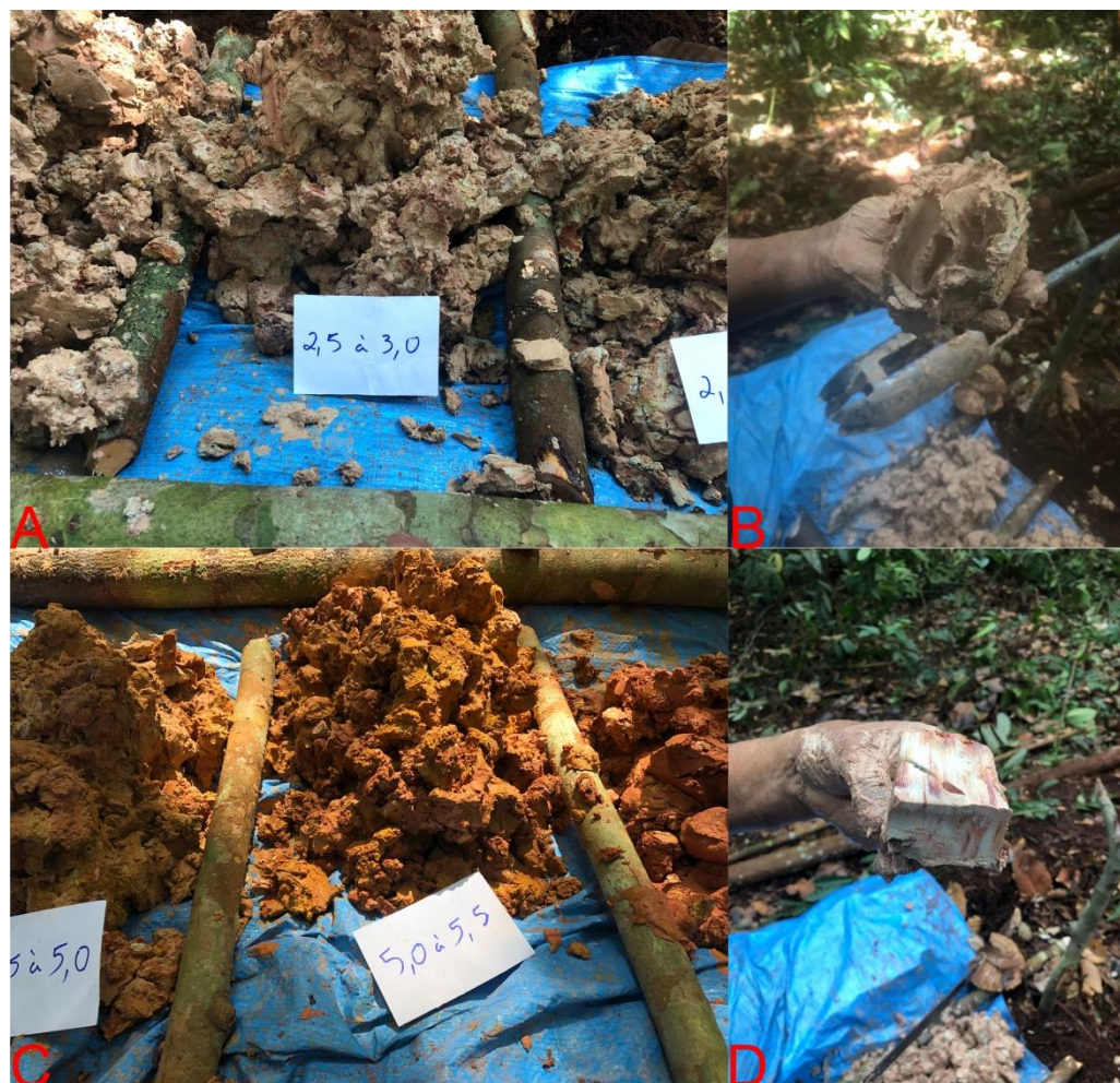
Figura 15: A) Material mosqueado amostrado do intervalo entre 2,50 a 3,00 metros, do furo TEF-03. B) O material coeso pode sair no formato da boca do trado. C) Material vermelho amostrado do intervalo entre 5,00 a 5,50 metros. D) O horizonte acamadado é coeso e pode ser cortado em blocos.
