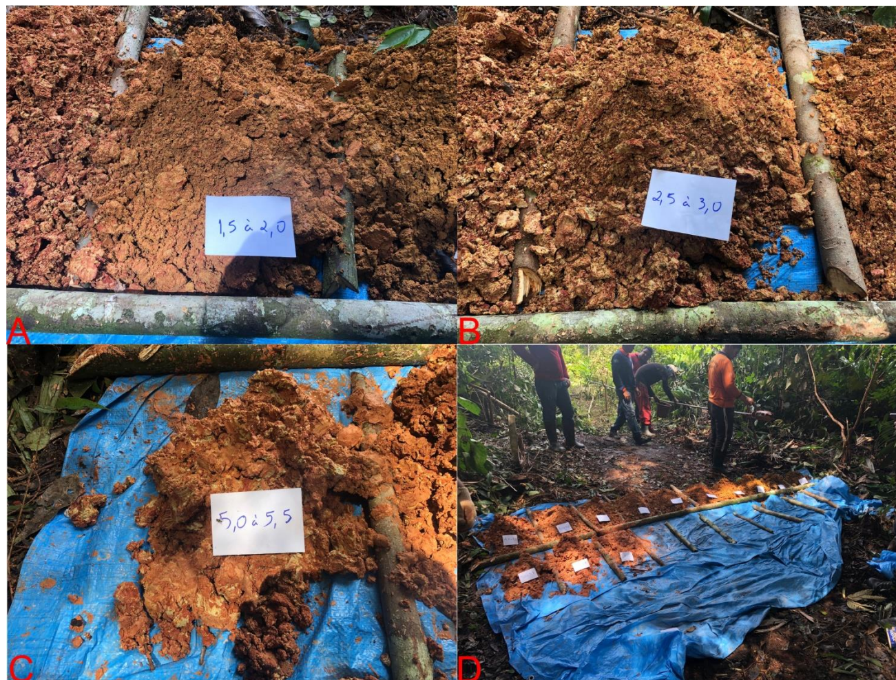
Figura 17: A) Material laranja/vermelho amostrado do intervalo entre 1,50 a 2,00 metros. B) Material laranja/mosqueado amostrado do intervalo entre 2,50 a 3,00 metros. C) Material vermelho/mosqueado amostrado do intervalo entre 5,00 a 5,50 metros. D) Disposição das amostras do trado na lona para coleta e análise.
