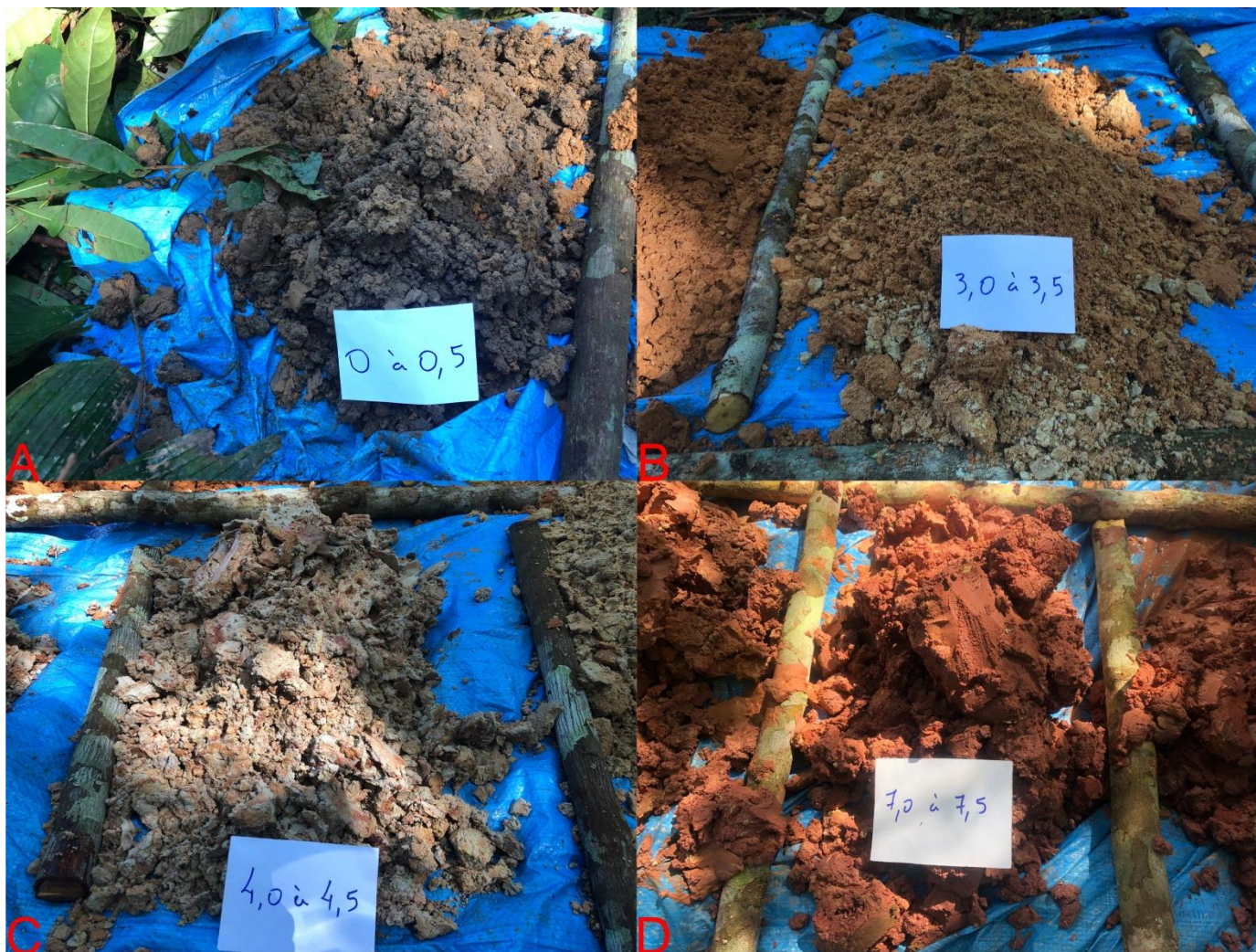
Figura 14: A) Material orgânico não amostrado do intervalo entre 0,00 a 0,50 metros, do furo TEF-02. B) Material laranja amostrado do intervalo entre 3,00 a 3,50 metros. C) Material branco amostrado do intervalo entre 4,00 a 4,50 metros. D) Material vermelho amostrado do intervalo entre 7,00 a 7,50 metros.
