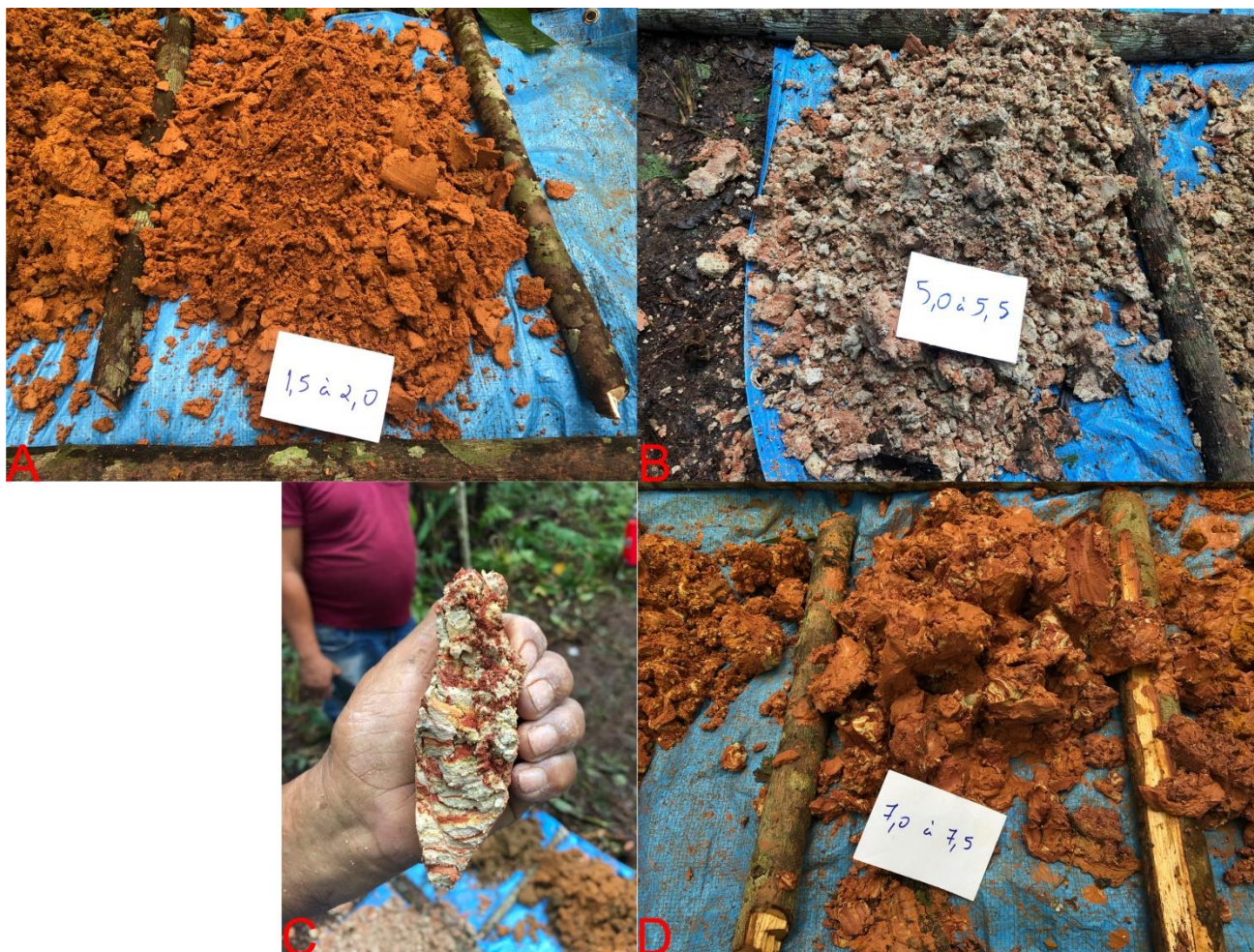
Figura 16: A) Material laranja/vermelho amostrado do intervalo entre 1,50 a 2,00 metros, do furo TEF-04. B) Material mosqueado amostrado do intervalo entre 5,00 a 5,50 metros. C) O material acamadado coeso pode ser retirado inteiro. D) Material vermelho amostrado do intervalo entre 7,00 a 7,50 metros.
