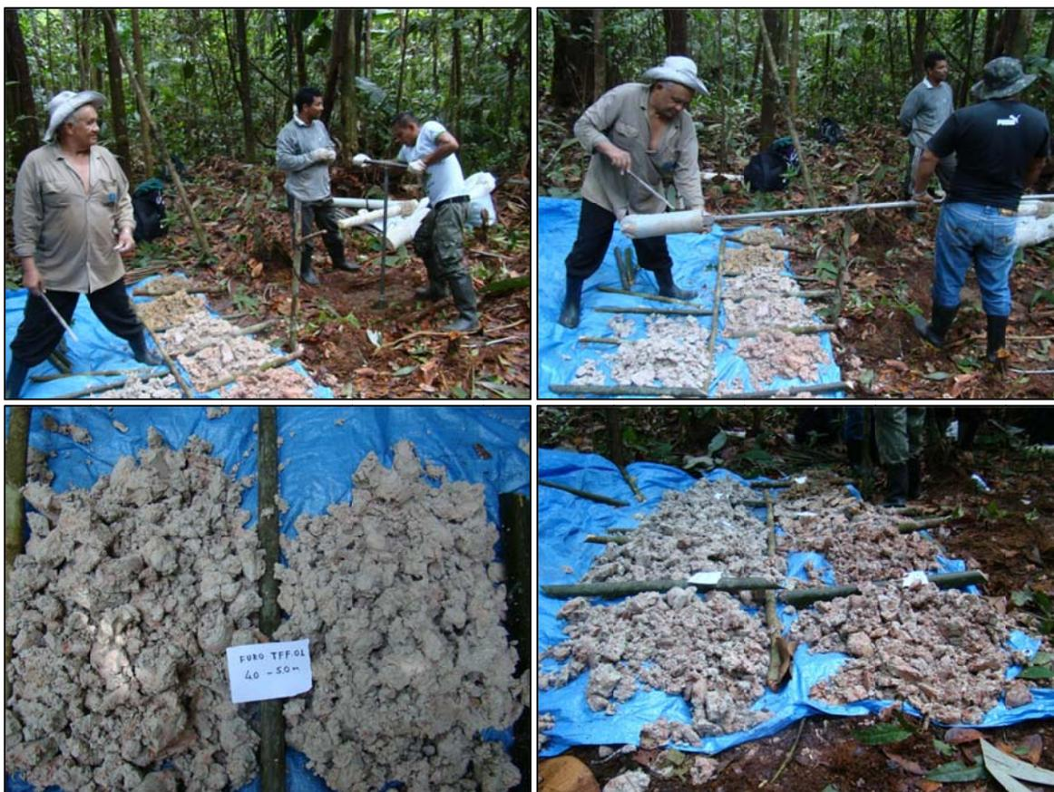
Figura 8: Aspectos da perfuração e do material argilo-siltoso atravessado pelo furo TFF-01.
