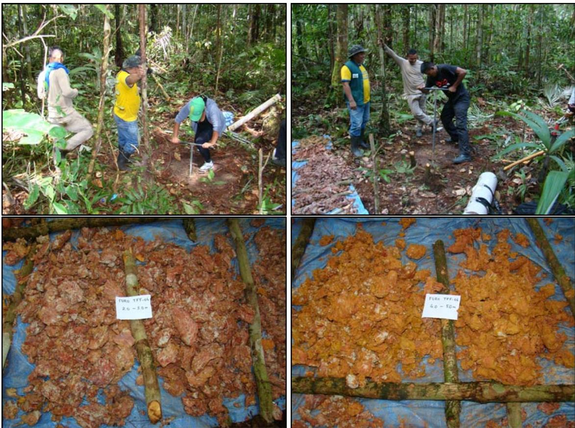
Figura 11: Aspectos da perfuração e do material atravessado em dois intervalos do furo TFF-04
