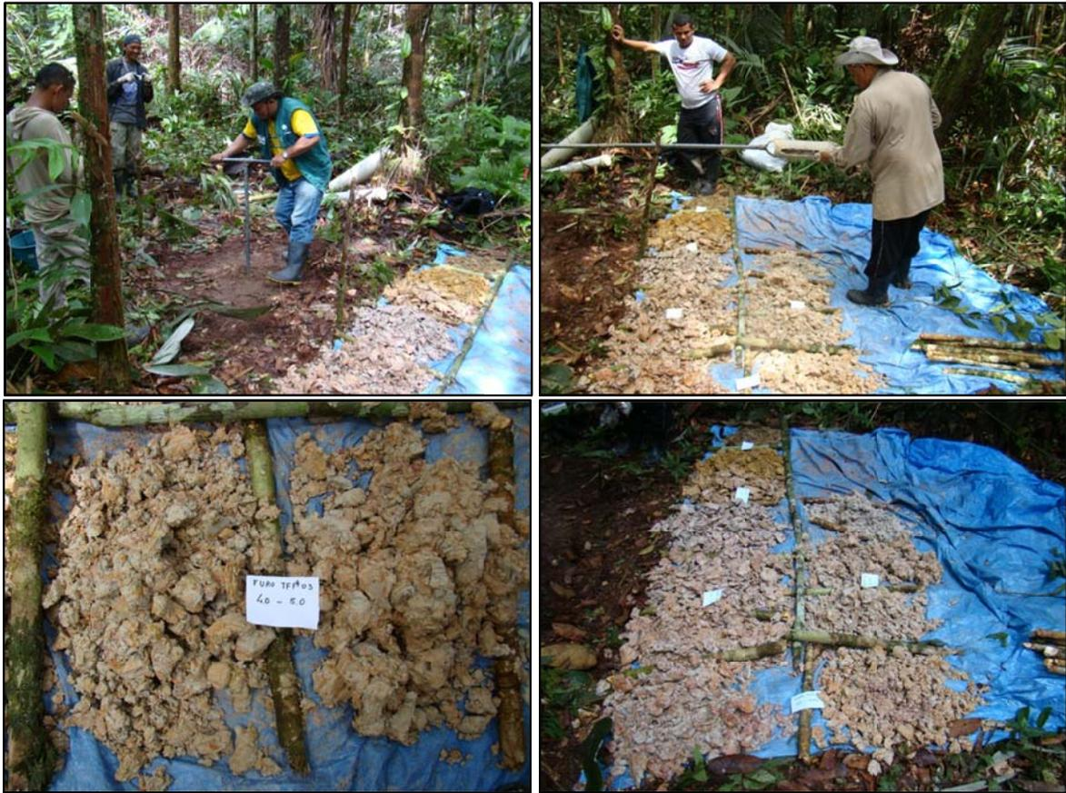
Figura 10: Aspectos da perfuração e do material argilo-siltoso atravessado pelo furo TFF-03.
