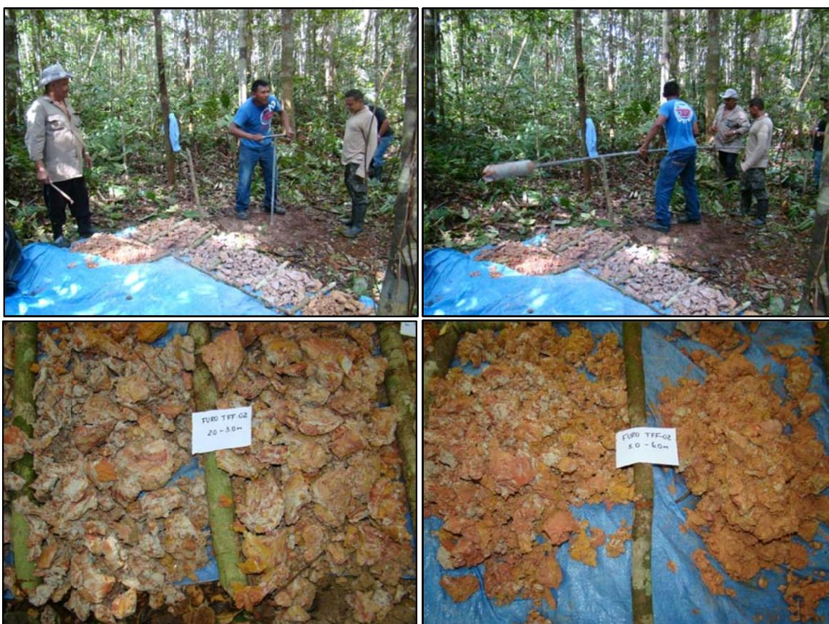
Figura 9: Aspectos da perfuração e do material atravessado em dois intervalos do furo TFF-02.
