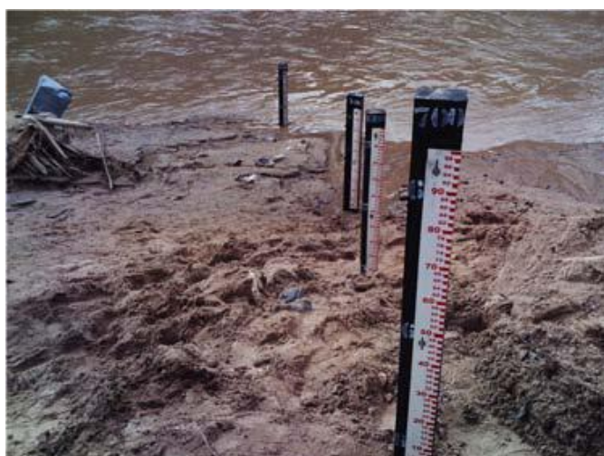
Figura 16 - Réguas da estação fluviométrica de Santana do Mundaú recuperadas após a cheia de junho de 2010. Fonte: SGB (2010).
