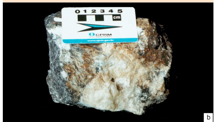
Figura 3.2.4.1.9 a) Calcáreo estromatolítico da Formação Terra Preta, região de Terra Preta, alto curso do rio Sucundurí; b) Amostra de calcário cinza escuro da Formação Terra Preta, cortado por veios e estreitas vênulas de magnesita, de cor branca. Sulfetos de cobre, em especial calcopirita, ocorrem disseminados na rocha calcária estromatolítica. Região de Terra Preta, alto curso do rio Sucundurí.
