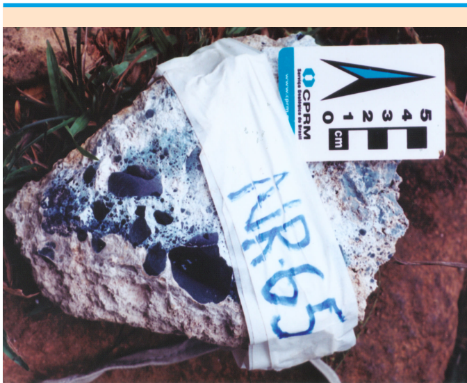
Figura 3.2.3.1.1 – Tufo lópilli do Grupo Colíder, região de Apuí, vicinal Gaúcha, Estado do Amazonas
