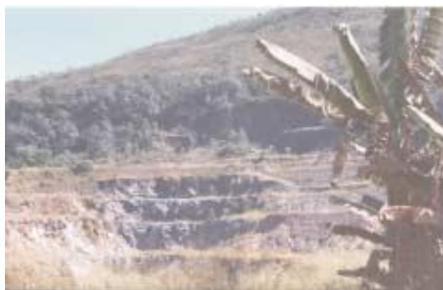
Foto 4.8 – Extração de rocha carbonática, a céu aberto, sob a forma de bancadas.
