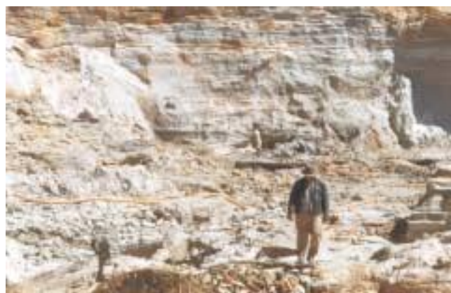
Foto 4.4 – Desmonte hidráulico de quartzito para retirada de areia.
