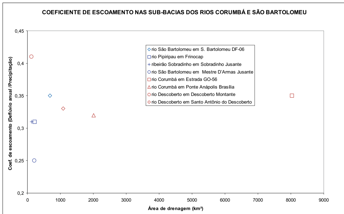
Figura 10.17 – Coeficiente de escoamento x área de drenagem.
