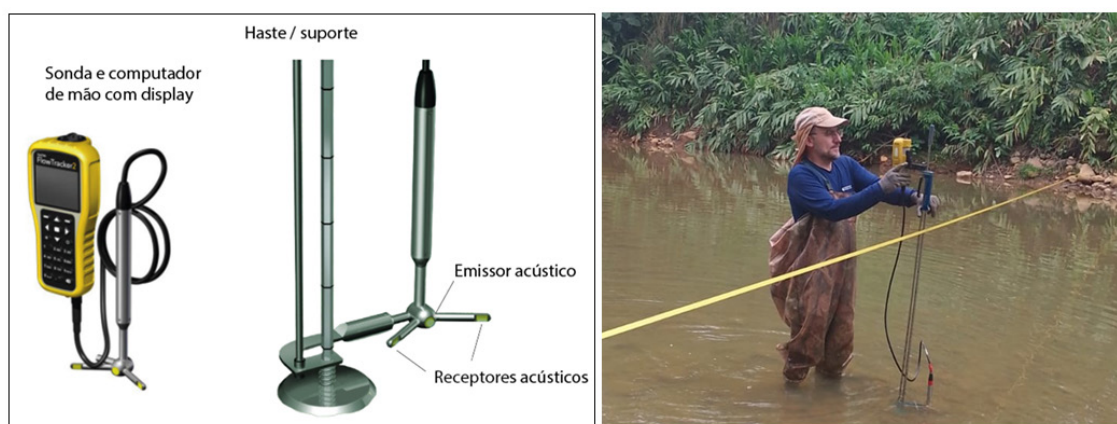
Figura 4 - À esquerda: representação do equipamento FlowTracker2. À direita, medição realizada por um técnico em um curso fluvial. Fonte: à esquerda SonTek (2019), à direita foto do arquivo do projeto.
