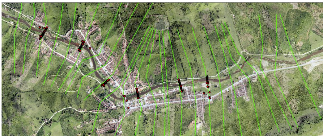
Figura 3 – Detalhe das 28 seções traçadas no MDE e das 06 seções transversais com batimetria no município de Santana do Mundaú – AL. Fonte: Elaborada pelos autores.
